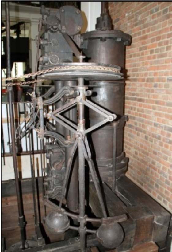
FIGURE 1.2 – Photo du régulateur de Watt, un des premiers exemples de régulateur de vitesse. Machine de Boulton et Watt de 1788, Science Museum, Londres.
