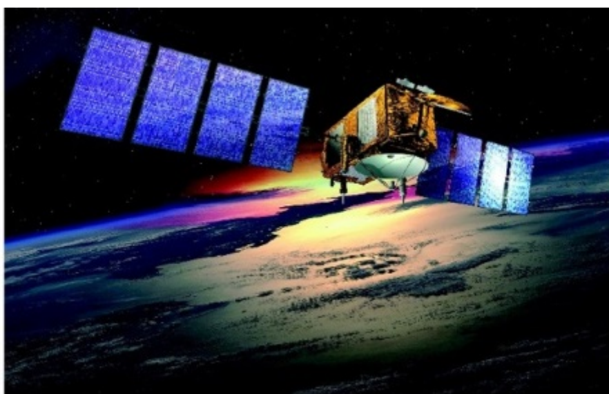
FIGURE 1.9 – Photo de Jason 2, un satellite d'observation des océans. (source : www.docsciences.fr/Jason-2-un-satellite-d-observation )
