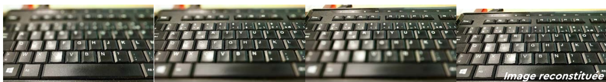
Figure II.27 : Exemple de compilation de 3 clichés ayant une mise au point différente afin de reconstituer un cliché où toute l'image est au point.
