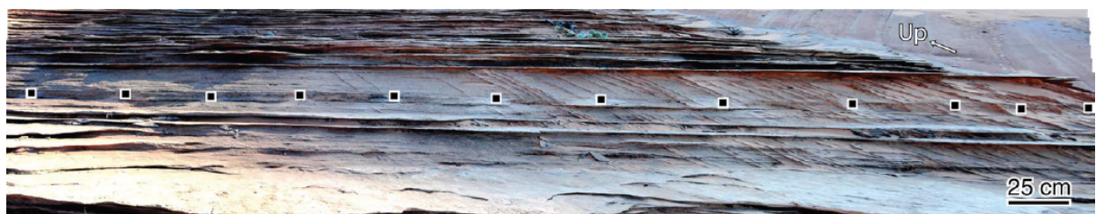
FIGURE 1.20 – Bandes de compaction pures observées dans le grès de Navajo, Utah par Fossen et al. (2011) ([61]). Photo montrant la variation de la densité des bandes de compaction le long l’écoulement du grain interstrates.
