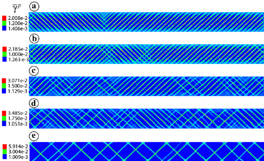
FIGURE 1.49 – Les motifs de \bar{\gamma}_p dans quatre modèles chargés au même raccourcissement horizontal total de 2.8 \times 10^{-2} m. (a) E = 5E_2 . (b) E = E_2 . (c) E = 0.5E_2 . (d) E = 0.3E_2 . (e) E = 0.05E_2 . La couche montrée est prise en sandwich entre deux autres couches non représentées (Chemenda et al. (2014) ([36])).
