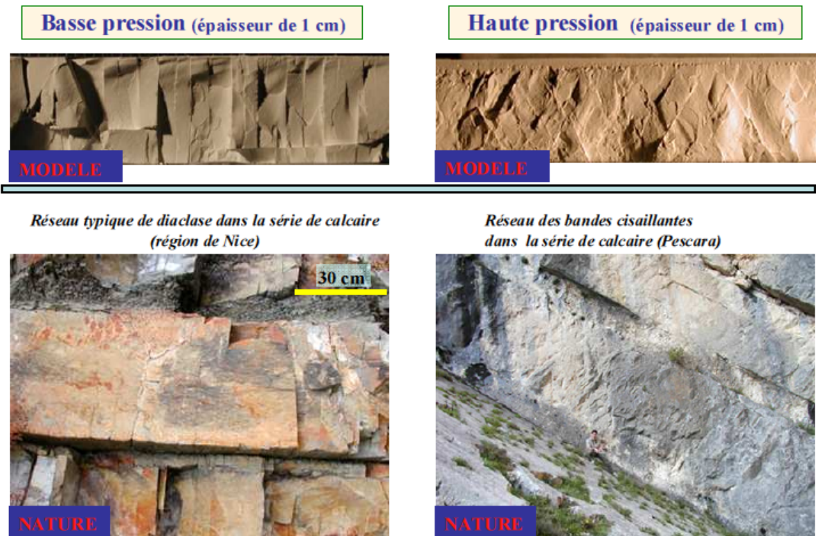
FIGURE 1.37 – Réseaux de fractures/bandes générés dans les modèle de GRAM1 et dans la nature (Jorand (2007) ([75]) cité par Nguyen (2009) ([98])
