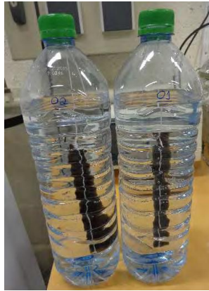
Figure II.17 : Éprouvettes de composites suspendues dans de l'eau pour le vieillissement hydrique.
