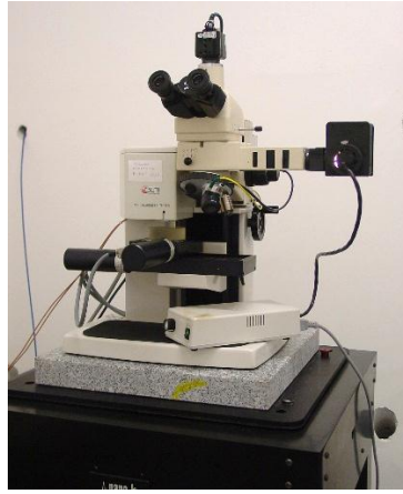
Figure II.20 : Nanoindenteur (CSM Instruments) utilisé.
