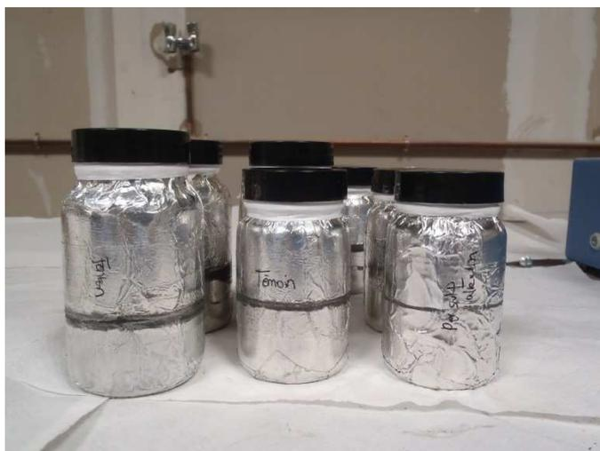
Figure 16. Flacons utilisés pour l'oxydation en réacteurs fermés
