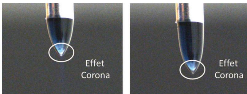
Figure III - 1 : Clichés de la pointe de l'aiguille de filage montrant l'effet corona observé pour les solutions de PEDOT:PSS/PVP
