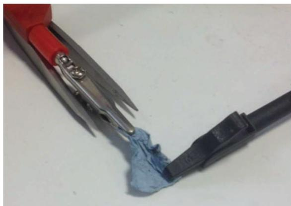
*Figure III - 35 : Photo d'une membrane conductrice autosupportée fabriquée par électrofilage*
