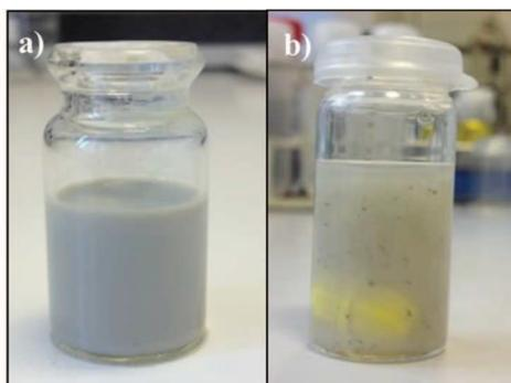
Figure IV - 20 : a) solution homogène de PVP:AgNFs, b) présence de fagots de nanofils d'Ag en suspension
