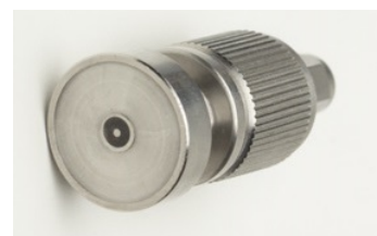
Fig. 2.4 – Exemple d'une sonde utilisée pour les mesures radio et hyperfréquences [97].
