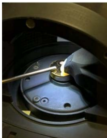
Figure V-3 : Montage pour l'aspiration des particules d'or durant les essais d'ablation en champ proche.
