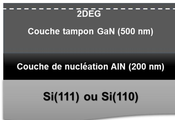
Figure 4.3 – Structure « mince » HEMT GaN (la structure cap / barrière / espaceur étant identique à celle de la structure épaisse, cf. Figure 4.2).
