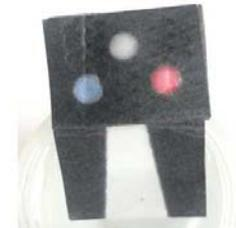
**Figure 6.53** – Démonstration de l'indépendance des microzones par des colorants bleu et rouge.
