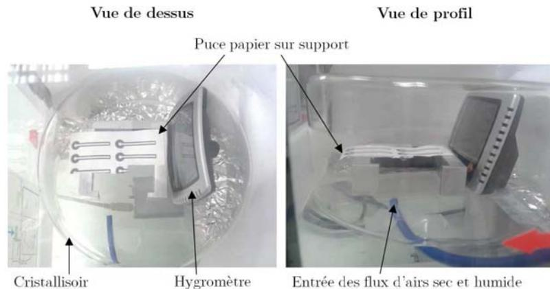
Figure 3.7 – Dispositif expérimental de contrôle de l'hygrométrie.
