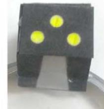
**Figure 6.52** – Distribution de la fluorescéine séchée dans le puits central, vers les trois microzones par l'écoulement depuis la bandelette.
