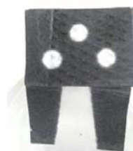
Figure 6.52 – Distribution de la fluorescéine séchée dans le puits central, vers les trois microzones par l'écoulement depuis la bandelette.
