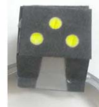
Figure 6.52 – Distribution de la fluorescéine séchée dans le puits central, vers les trois microzones par l'écoulement depuis la bandelette.
