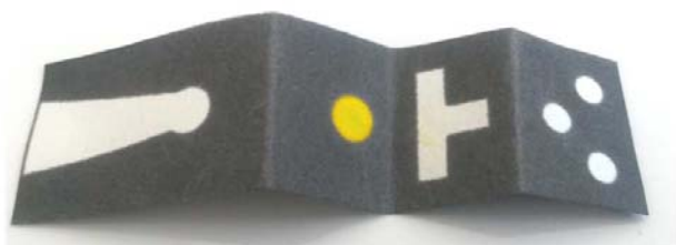
Figure 6.52 – Distribution de la fluorescéine séchée dans le puits central, vers les trois microzones par l'écoulement depuis la bandelette.
