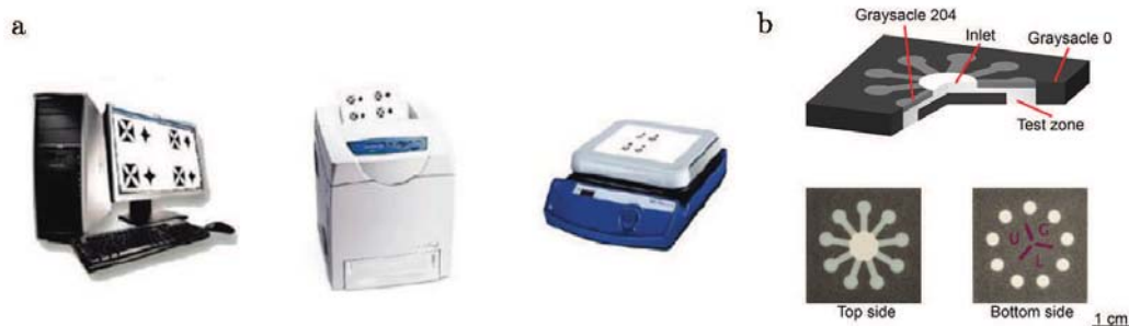
Figure 1.14 – Dispositif expérimental pour l'impression de barrières de cire et pénétration de la cire dans le papier selon la teinte imprimée.
