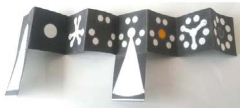
Figure 6.56 – Transport vers les microzones de fluorescéine séchée dans les puits centraux de la puce papier à neuf puits.
