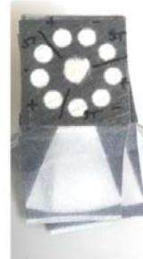
Figure 6.56 – Transport vers les microzones de fluorescéine séchée dans les puits centraux de la puce papier à neuf puits.
