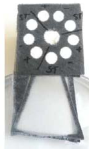
Figure 6.57 – Démonstration de l'indépendance des microzones, dans la puce papier à neuf puits, par des colorants bleu et rouge.
