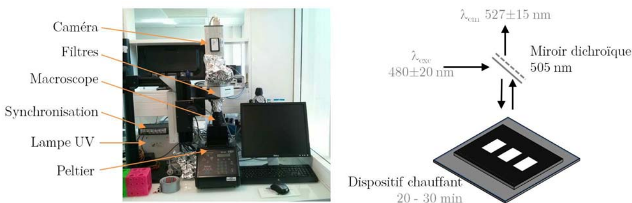
Figure 6.9 – Montage expérimental au laboratoire pour l'amplification et la détection d'acides nucléiques sur papier.
