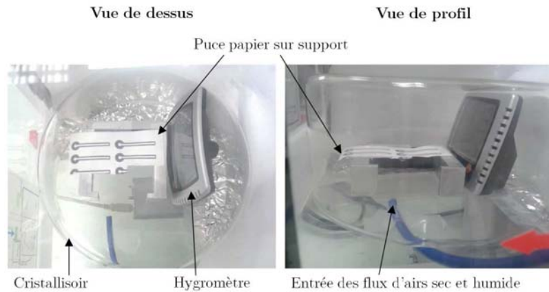
Figure 3.7 – Dispositif expérimental de contrôle de l'hygrométrie.
