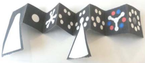
Figure 6.57 – Démonstration de l'indépendance des microzones, dans la puce papier à neuf puits, par des colorants bleu et rouge.
