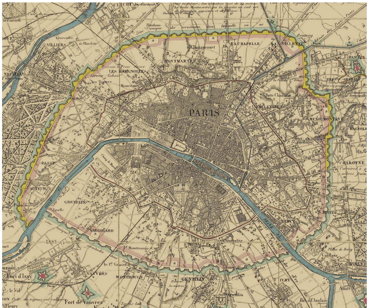
Figure 9 : Carte des fortifications de Thiers, réalisée vers 1841. Les fossés longeant les remparts sont représentés en bleu clair et longés par une bande qui sera la zone non-constructible des servitudes militaires (légendée sur la carte comme suit : « zone unique des servitudes dans laquelle on ne pourra plus bâtir »). Source : http://www.parismetropolitaine.fr/naissancesdes20arrondissementsparisiens/diapo1-2.html , consulté le 03/07/2015.
