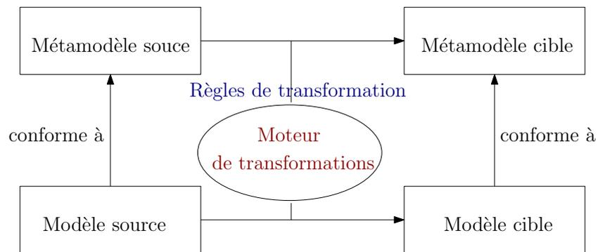
Figure 2.8 – Principe de transformation de modèles
