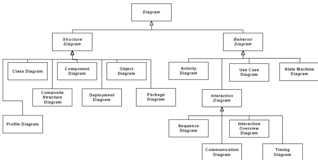
Figure 3.1 – Les différents diagrammes de UML2 [OMG, 2011]
