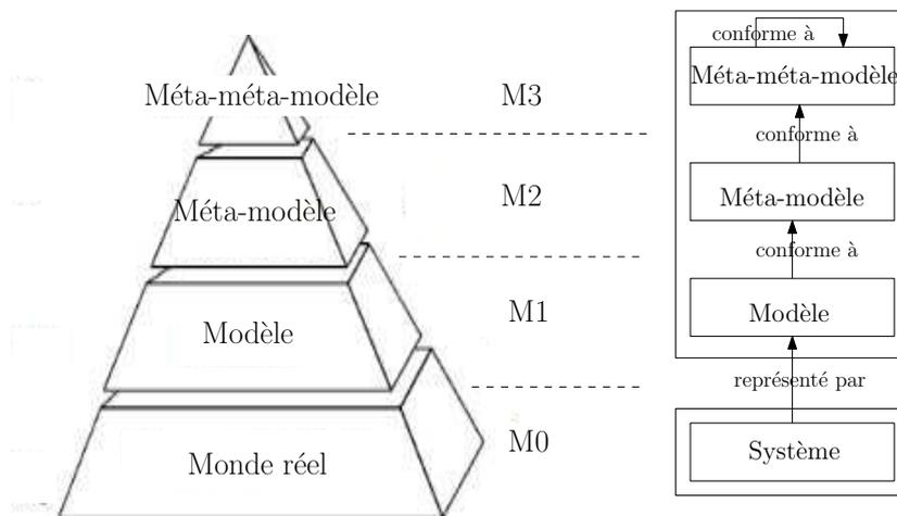
Figure 2.4 – Les quatre niveaux de l'architecture de l'IDM
