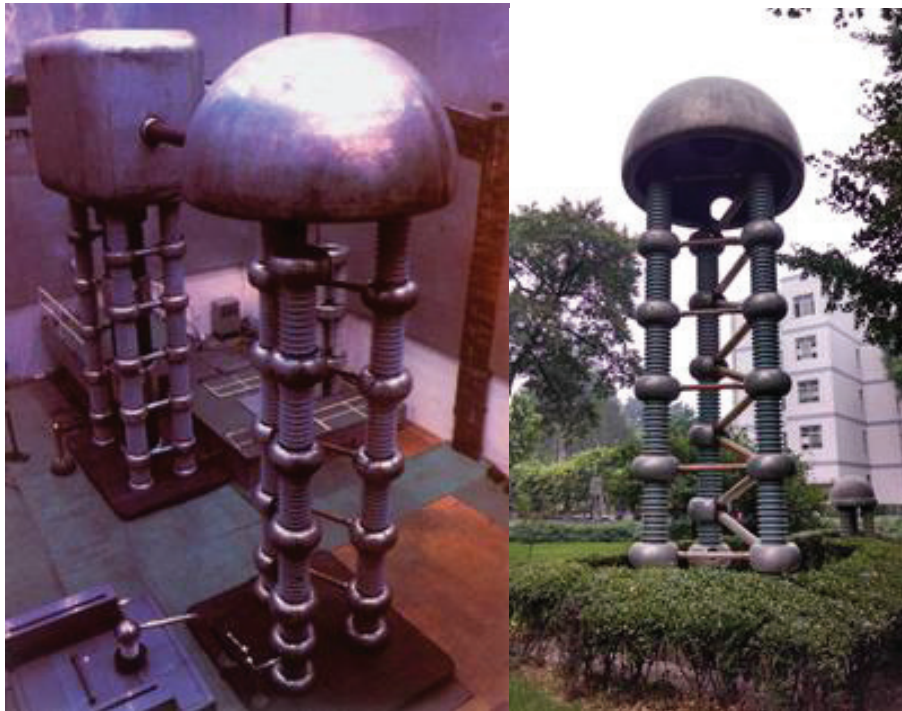
Figure 46 : accélérateur Cockcroft-Walton du Beijing Proton LINAC en 2002 (a) et partie d'un accélérateur Cockcroft-Walton remonté à l'extérieur devant l'Institut Physique des hautes énergies de Beijing (b) en 2014, Chine. Droits photographiques : Institut Physique des hautes énergies de Beijing et Richard Ruiz. Source : (Institute of High Energy Physics, 2002; Ruiz, 2014)
