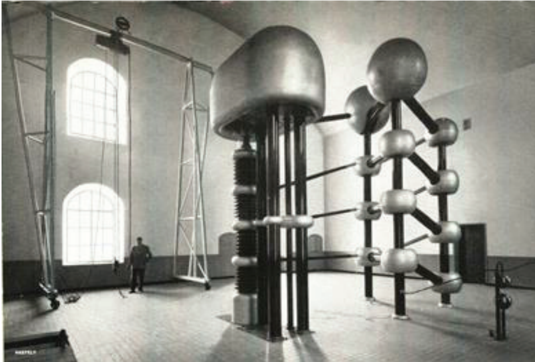
Figure 21 : Extrait de la brochure commerciale de la société Haefely dans les années 1950-1960. La photographie montre l'accélérateur Cockcroft-Walton Haefely vendu au professeur Thibaud, monté à l'intérieur du fort de La Vitriolerie à Lyon. Droits et Source : Haefely
