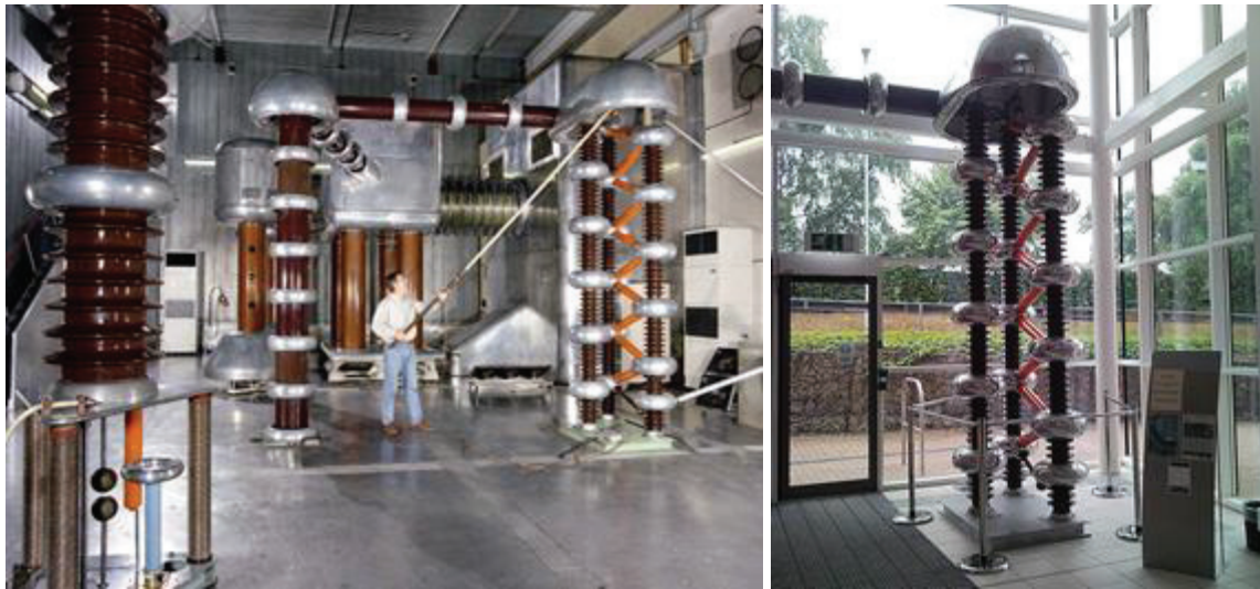
Figure 36 : accélérateur Cockcroft-Walton lors de sa période d'utilisation (a) (1984-2004) et remonté partiellement dans l'entrée de l'Institut Cockcroft à Daresbury (b) en 2011.
