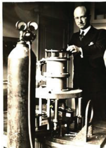
Figure 22 : L'accélérateur de particules à 1 million de volts (a) du Centre de perfectionnement en physique nucléaire (Lyon). A : le générateur à haute tension continue (1 million de volts), avec redresseurs au sélénium. B : le tube accélérateur proprement dit, à 4 étages. La source d'ions (Hydrogène lourd) est sous l'écran E. En T, les cibles où l'on déposera les éléments à transmuter par bombardement, après déviation des particules au spectromètre magnétique. En P, les pompes et le contrôle de vide. En C, le pupitre de commande et de contrôle et la salle des machines (Légende originale). Le professeur Thibaud à l'Institut de physique atomique, rue Raulin (Lyon) Source : (Thibaud, 1946) et les archives de l'IPNL.
