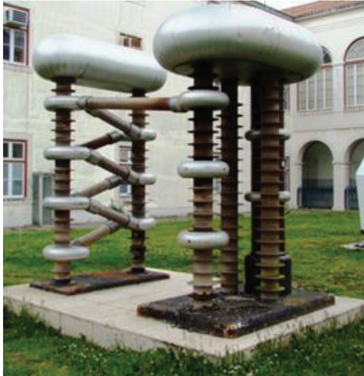
Figure 44 : Partie supérieure de l'accélérateur de particules Cockcroft-Walton remonté sur la pelouse de l'Université scientifique de Lisbonne. Droits et sources : (« Thesaurus do Património », 2016)
