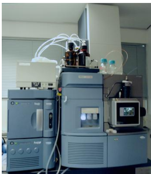
Figure 24: Photographie du système Acquity UPLC H-Class (Waters, Milford, USA) couplé au spectromètre de masse Xevo G2 S Q-TOF.
