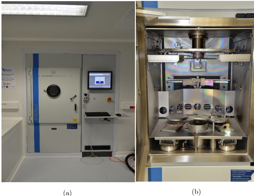
Figure 2-1 : Leybold Optics SYRUSpro 710 en environnement salle blanche (Espace Photonique) : (a) l'interface du bâti, (b) son intérieur (canons à électrons et assistance plasma, porte-substrats...)
