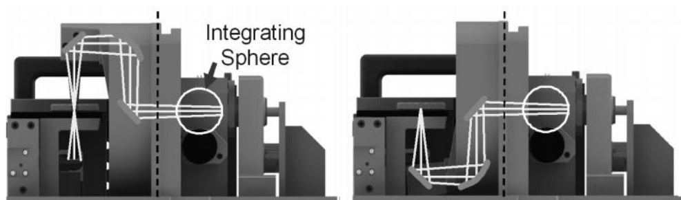
Figure 3-4 : Module 8RT du spectrophotomètre Lambda 1050. A gauche configuration pour la mesure en transmission. A droite configuration de la mesure en réflexion
