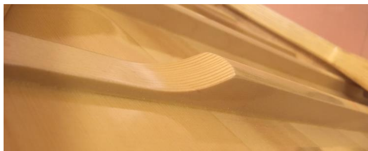
Figure I-6 : Décroissance lente en sifflet de la hauteur des barres de renforts d'un piano.
