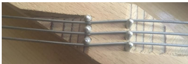
Figure I-4 : Couplage des cordes avec la table d'harmonie par un système de doubles pointes formant une chicane.
