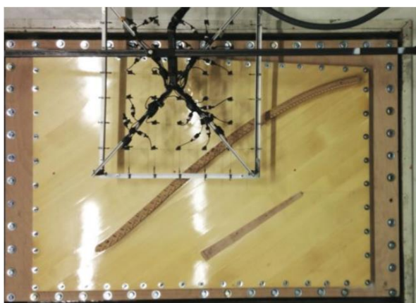
Figure III-33 : Montage de la table dans la fenêtre de transparence d'une salle réverbérante vue du côté chevalet. Le montage permet de réaliser les conditions d'encastrement et de baffle nécessaires à la comparaison expérimentale avec le modèle.
