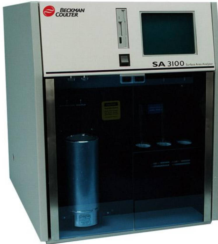
Fig II-8 : Appareil de volumétrie d'adsorption d'azote automatisé de type Multi-points Beckman Coulter surface analyzer SA 3100.
