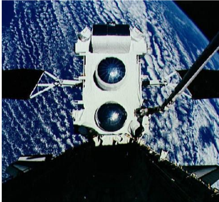
FIGURE 1.2 – Photographie du satellite CGRO , prise de la navette spatiale lors de son déploiement.
