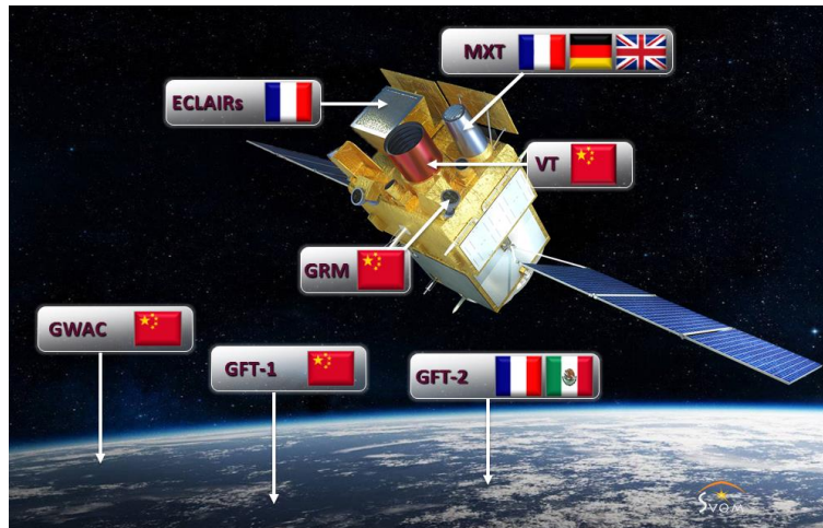
FIGURE 1.12 – La mission SVOM avec ses instruments grand-champ GRM, ECLAIRs, GWAC et ses instruments petit-champ MXT, VT et GFT.
