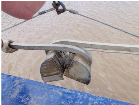
Figure 2.2 : Benne Van Veen utilisée lors de l'échantillonnage en zone subtidale.
