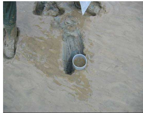
Figure 2.3 : Carottier à main utilisé lors de l'échantillonnage en zone intertidale.
