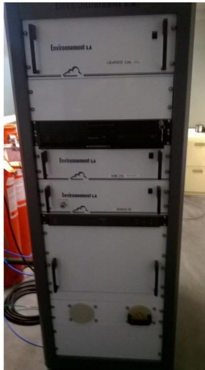
Figure 3.6- Photographie de l'armoire d'analyse de gaz en continu, ENVIRONNEMENT SA.
