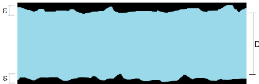
Figure 2.7 : Rugosité interne de la conduite
