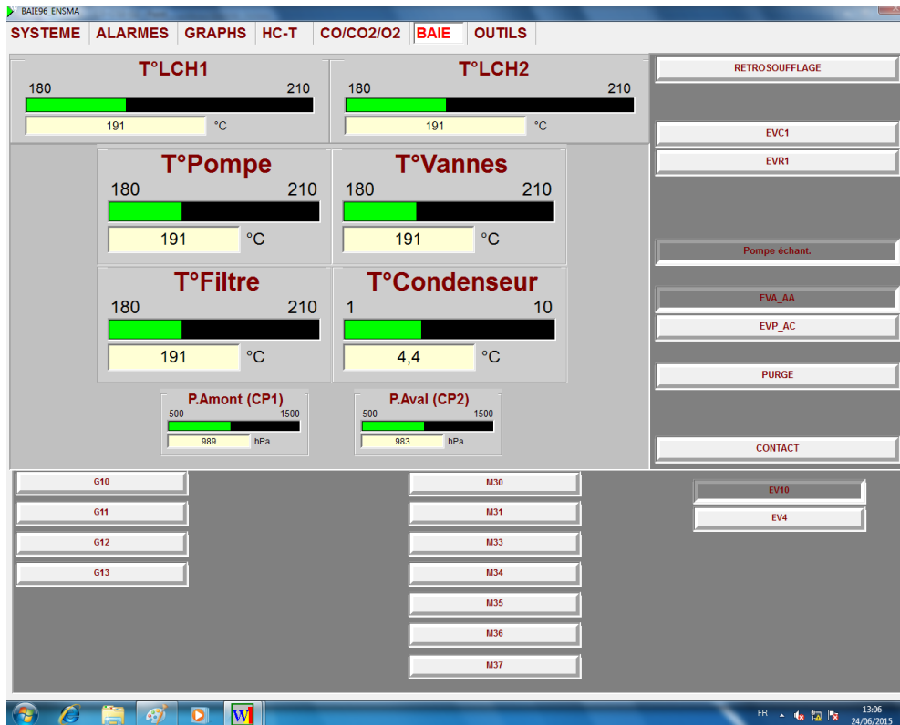
Figure 3.8 : Interface graphique de WinScan pour le contrôle des températures et pressions
