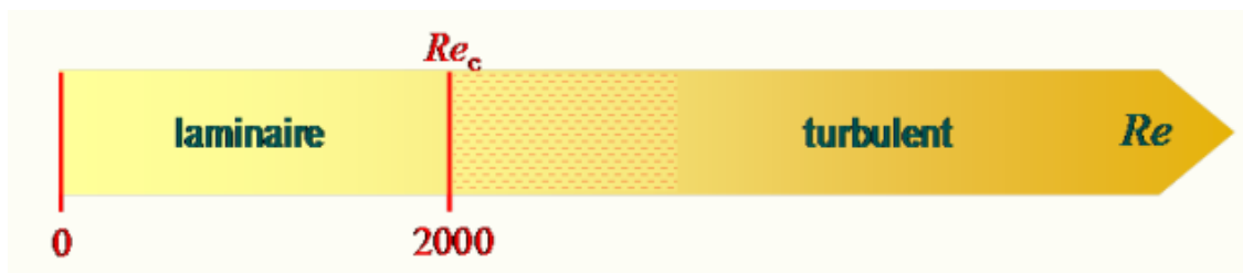
Figure 2.5 : Régime de turbulence en fonction du nombre de Reynolds
