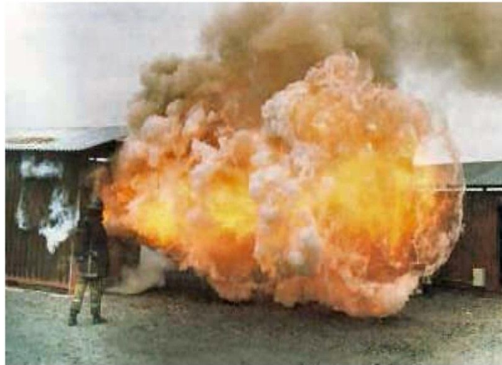
Figure 25 : Déflagration d'un backdraft dans un conteneur d'expédition: boule de feu.
