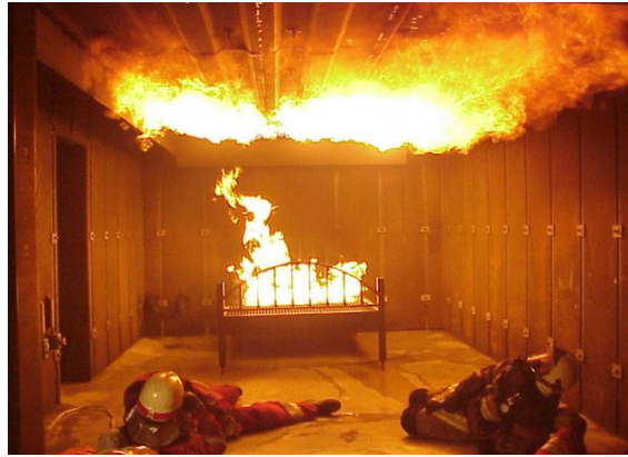
Figure 1.24 : Embrassement généralisé éclair d'une chambre d'essais : Flash-Over
