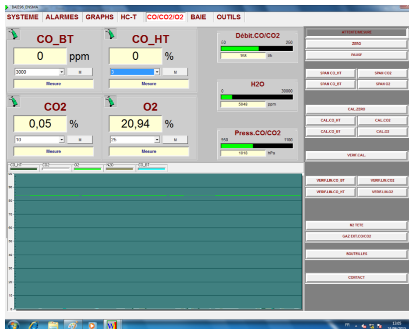
Figure 3.7 : Interface graphique de Winscan permettant la lecture des concentrations des gaz analysés
