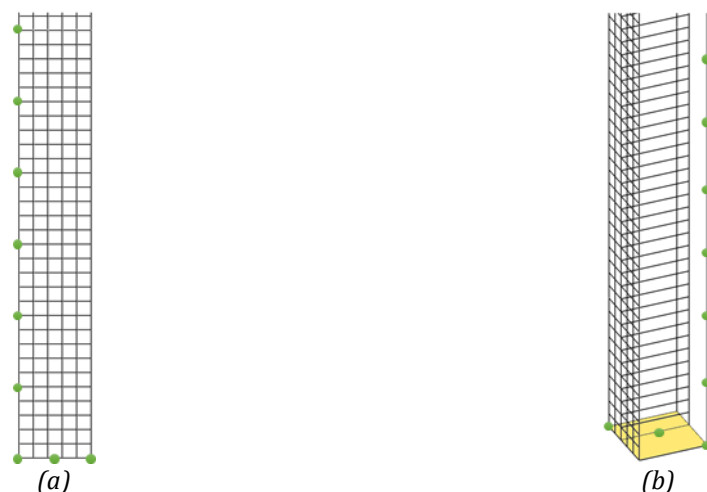
Figure 38 : Bas du domaine, (a) maillage et instrumentation (en vert), tous les mm en hauteur ; (b) visualisation de la configuration pseudo-1D
