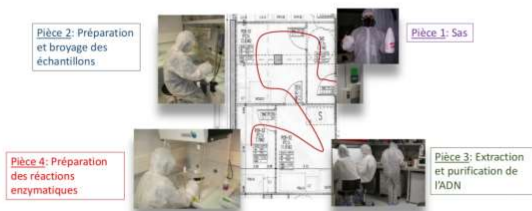
Figure 3 : représentation schématique du laboratoire de haut-confinement de l'Institut Jacques Monod.
