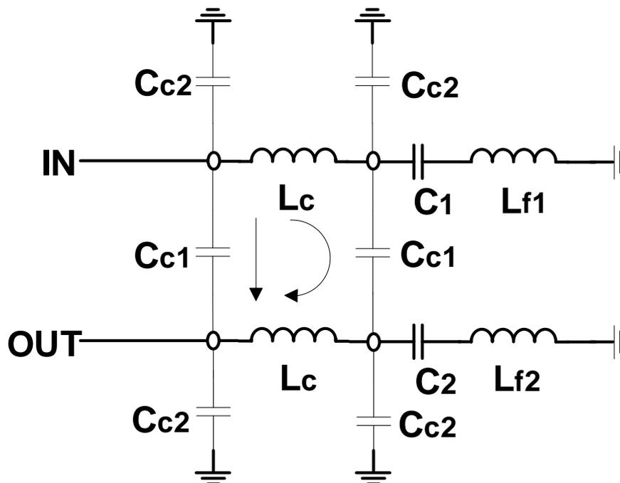
Figure IV-5 : Topologie du filtre en éléments localisés.
