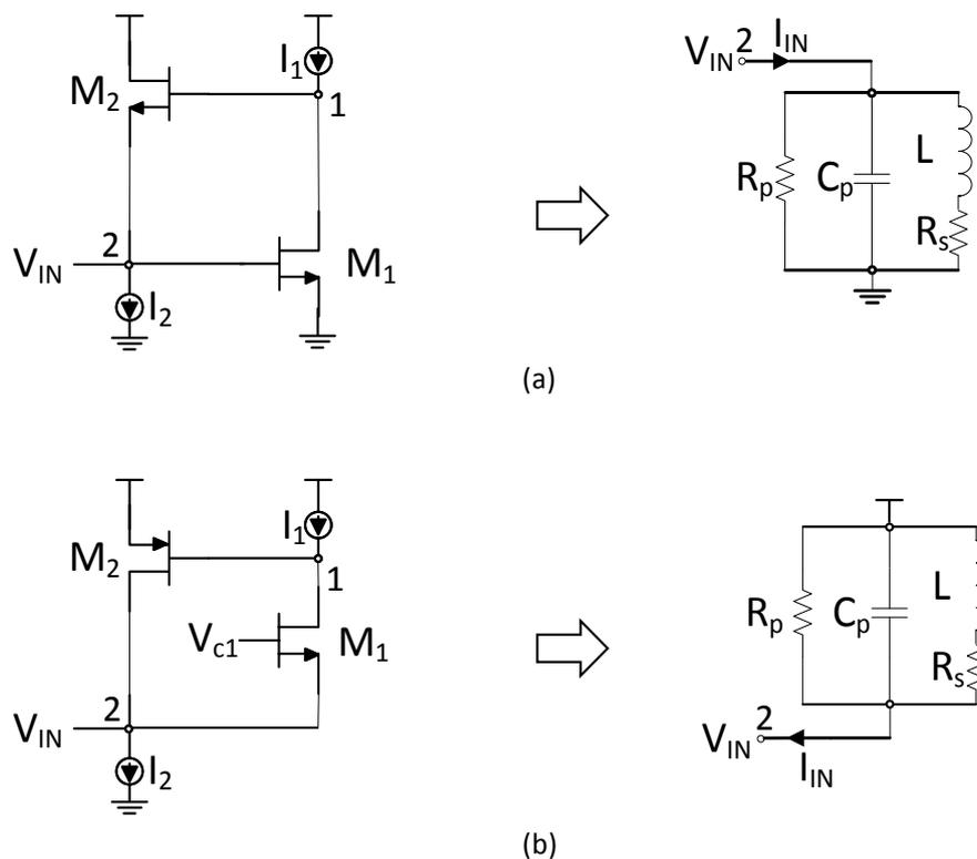
Figure II-1 : Topologies de base d'une inductance active, (a) : Gyrateur avec voie directe formée par une transconductance négative et voie inverse formée par une transconductance positive, (b) : Gyrateur avec voie directe formée par une transconductance positive et voie inverse formée par une transconductance négative [51].
