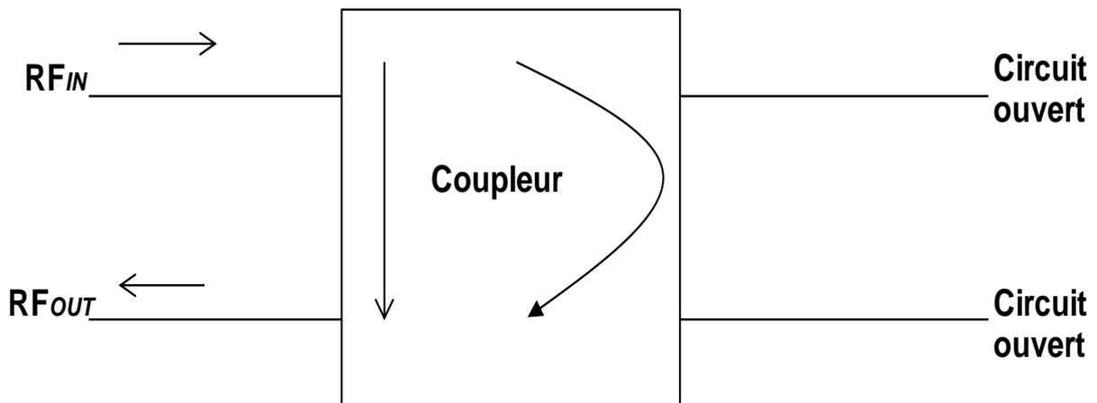
Figure IV-3 : Schéma de principe du filtre bi-bande.
