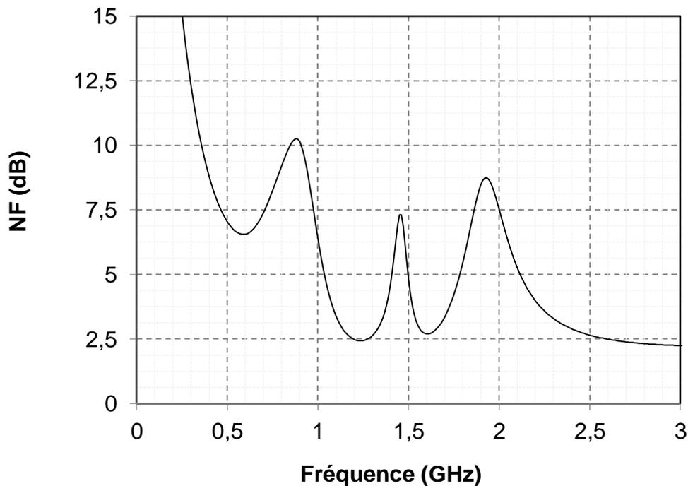
Figure IV-15 : Niveau de bruit du LNA-Filtre bi-bande.
