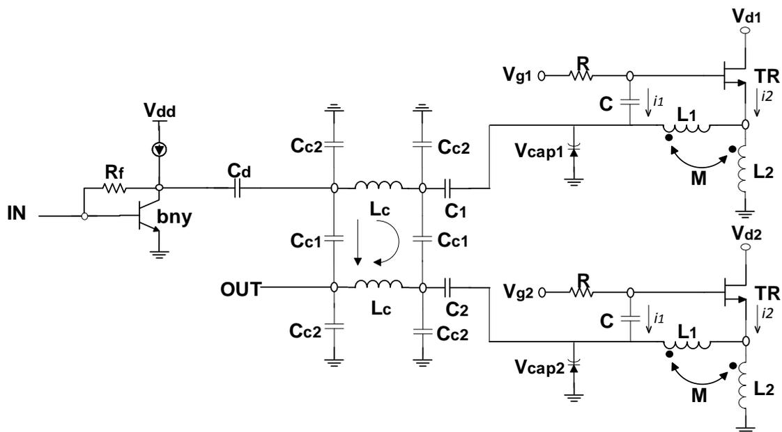
Figure IV-11 : Schéma électrique simplifié du circuit LNA filtrant.
