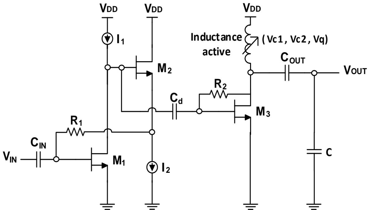
Figure II-15 : Schéma électrique simplifié du LNA conçu.
