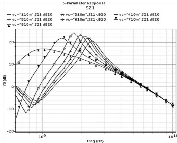
Figure II-14 : Variation de la fréquence centrale du LNA [53].
