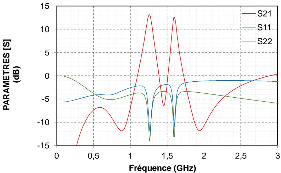
Figure IV-14 : Paramètres [S] du circuit LNA-Filtre bi-bande.
