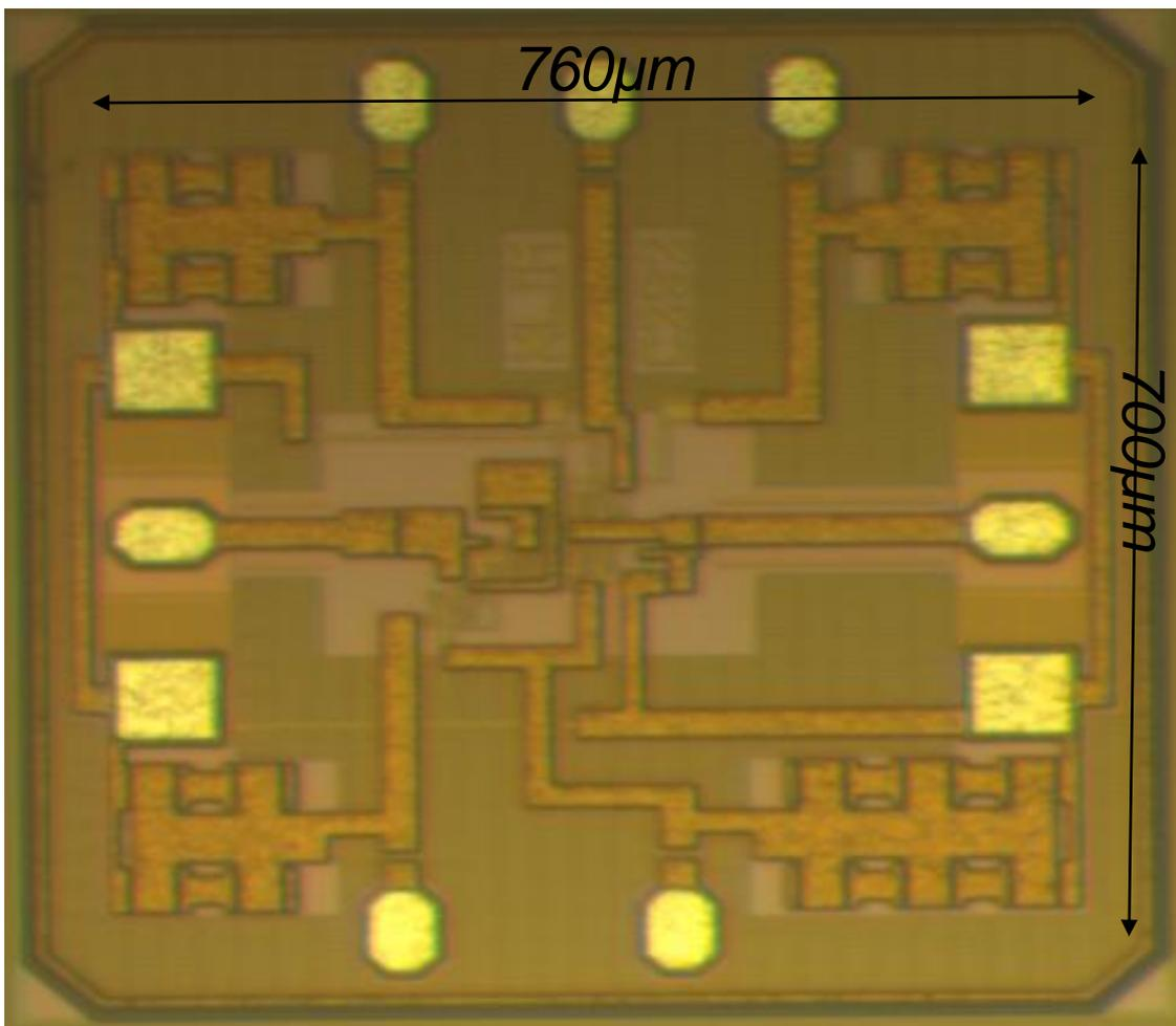
Figure II-22 : Photographie du circuit de LNA conçu.
