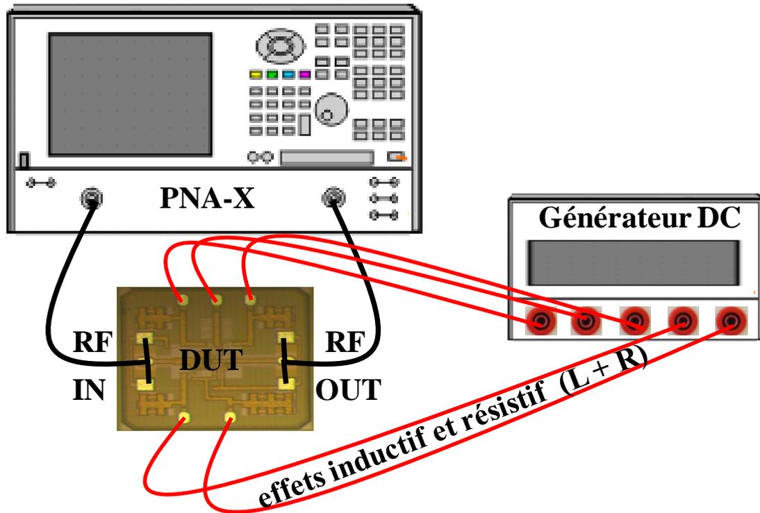
Figure II-17 : Diagramme simplifié du banc de mesure utilisé.
