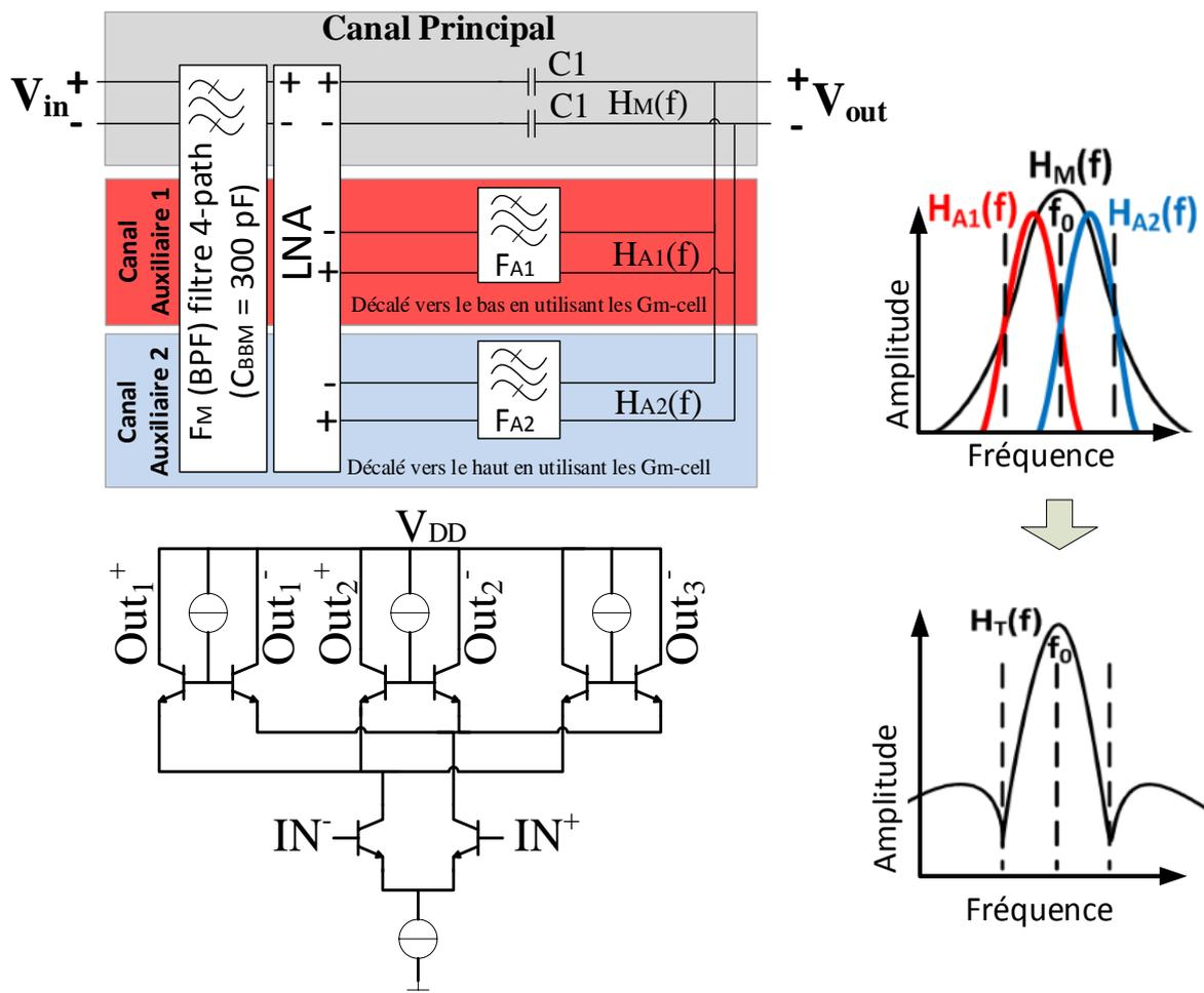
Figure III-9 : Schéma électrique simplifié du circuit global.
