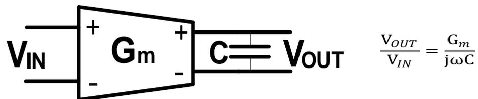
Figure I-1 : Principe des filtres actifs G<sub>m</sub>-C.
