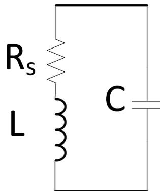
Figure I-6 : Résonateur RLC sans circuit de compensation.
