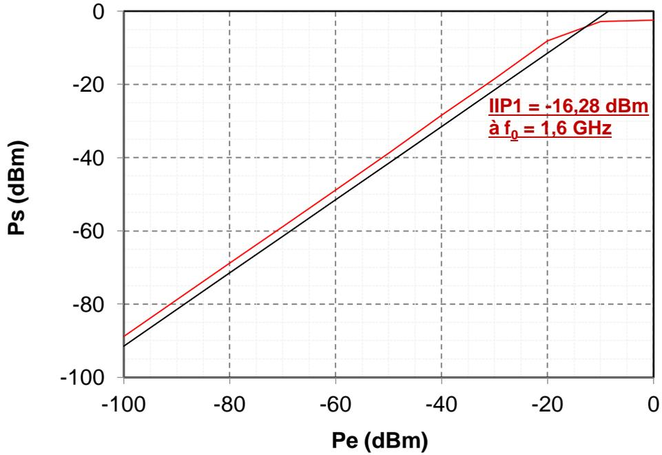
Figure IV-16 : Point de compression à -1 dB (IIP1) du circuit LNA-Filtre bi-bande à la fréquence 1,6 GHz.
