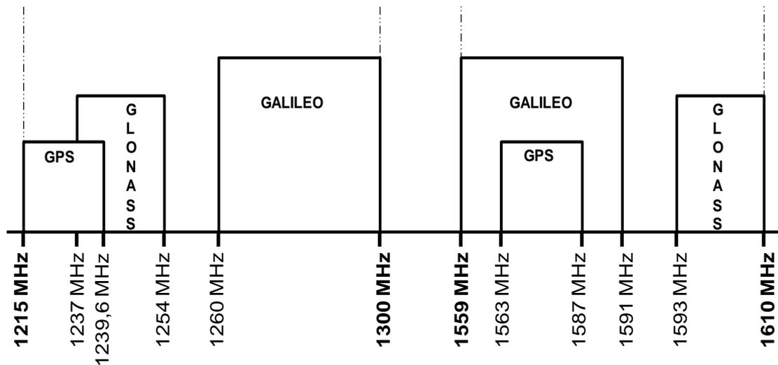
Figure IV-1 : Bandes de fréquences du système GNSS.
