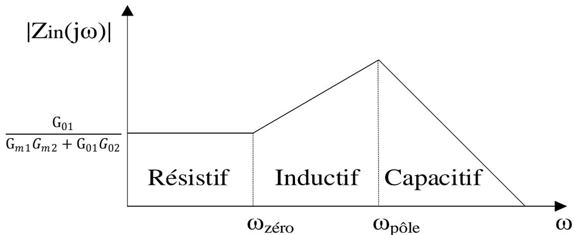
Figure I-4 : Comportement fréquentiel du gyrateur-C avec pertes.
