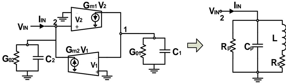
Figure I-3 : Principe de base du montage gyrateur.
