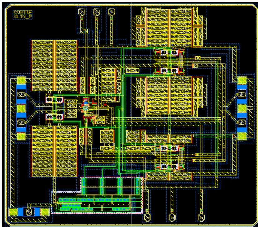
Figure III-17 : Dessin du masque du circuit réalisé.
