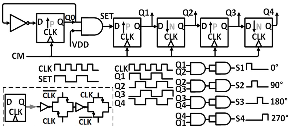
Figure 1 : Schéma bloc du générateur d'horloge utilisé.
