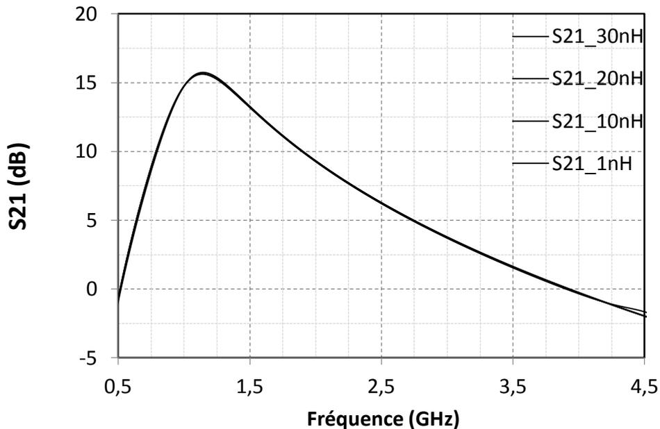
Figure II-19 : Suppression de l'impact de l'impédance sur le coefficient de transmission  $S_{21}$ .
