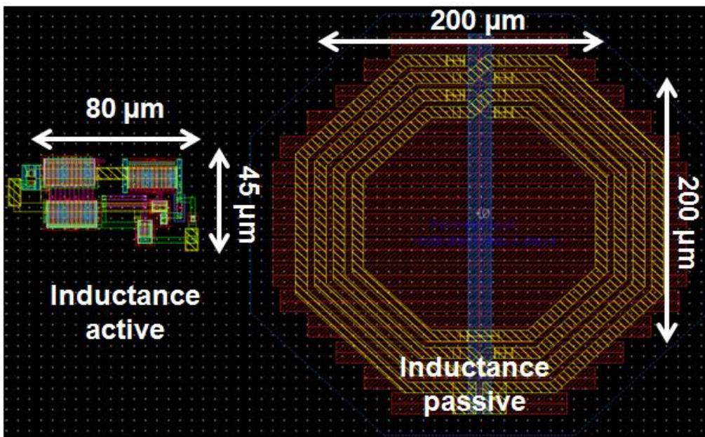
Figure II-21 : Comparaison entre les surfaces des inductances actives et passives.
