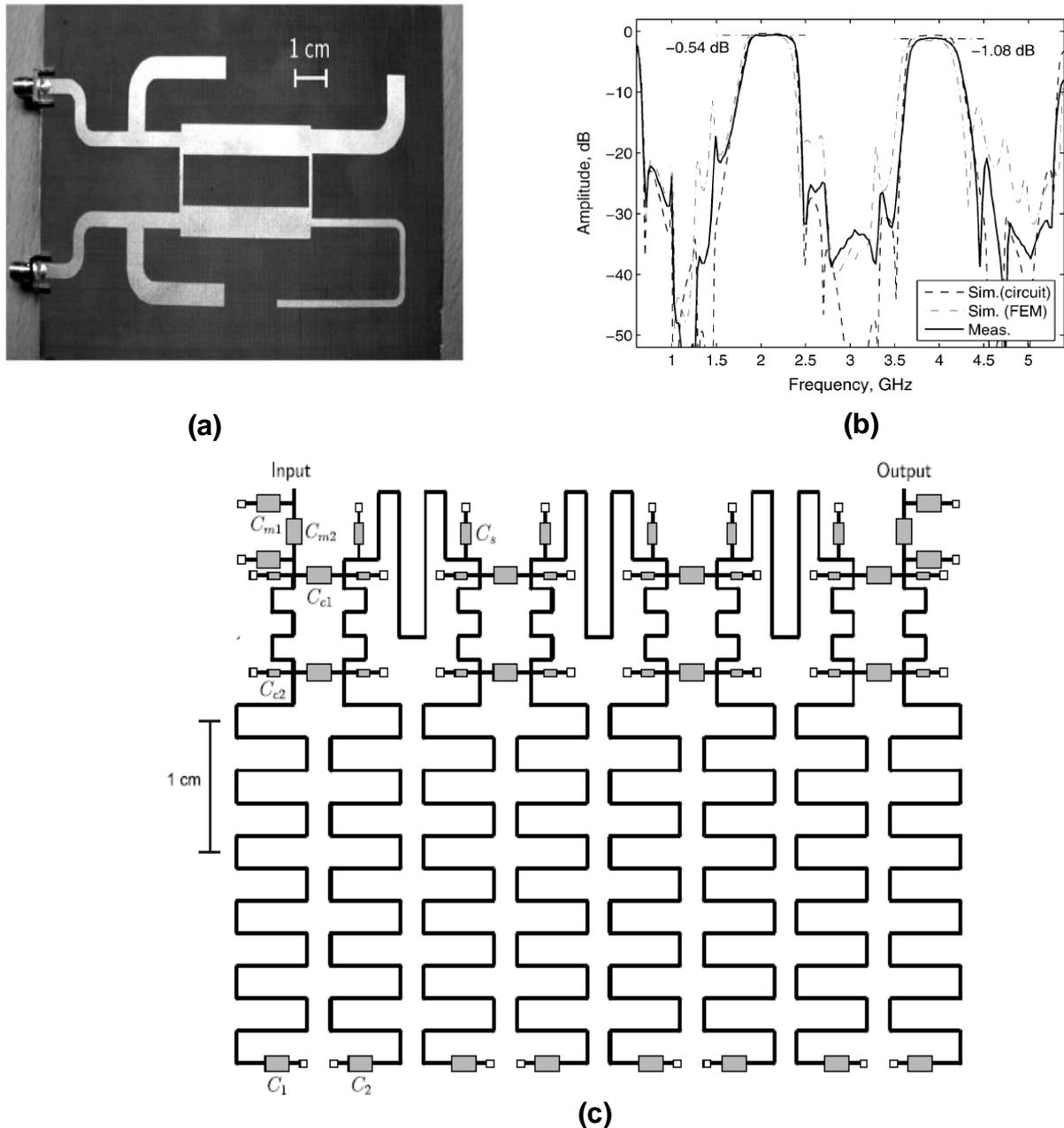
Figure IV-4 : Topologies et coefficient de transmission du filtre bi-bande déjà réalisé, (a) : Filtre conçu en technologie hybride [126], (b) : Coefficient de transmission  $S_{21}$  du filtre conçu en technologie hybride+ [126], (c) : Filtre conçu avec en éléments distribués [127].
