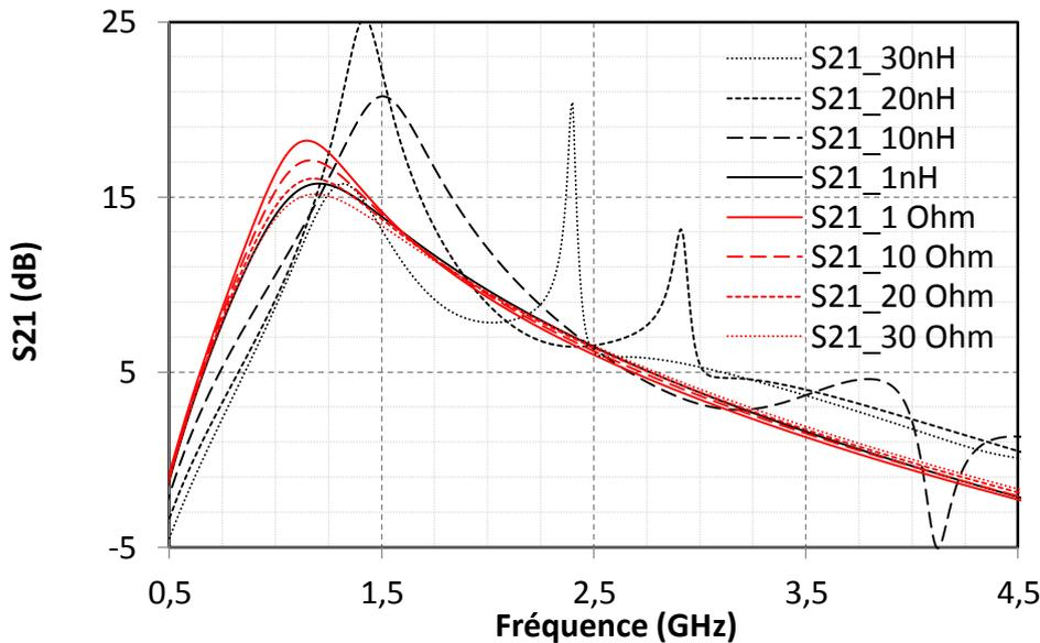
Figure II-18 : Coefficient de transmission  $S_{21}$  avec différentes impédances.
