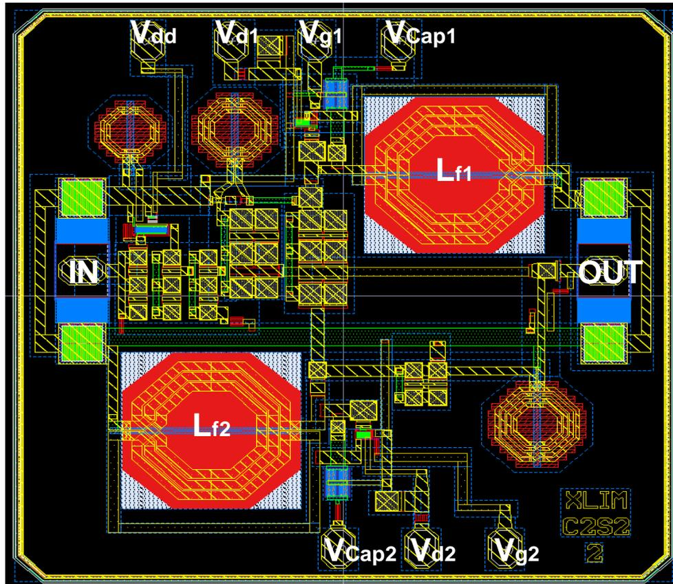
Figure IV-12 : Dessin des masques du circuit LNA-Filtre bi-bande.
