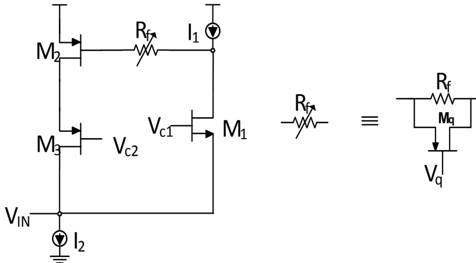
Figure II-6 : Nouvelle topologie d'inductance active proposée.
