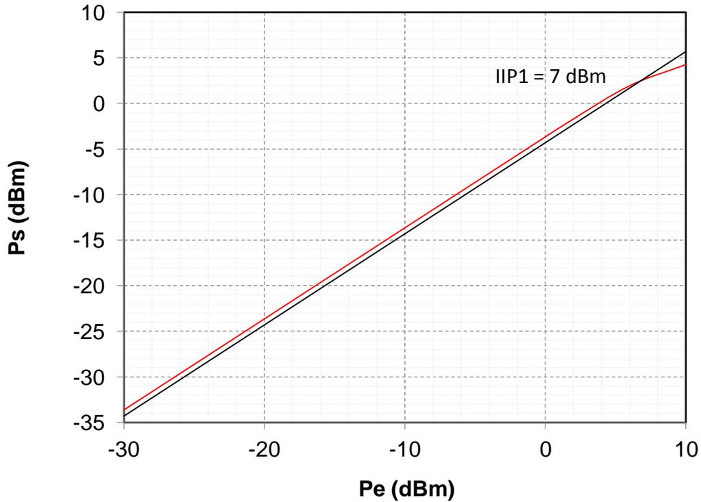
Figure III-5 : L'IIP1 du filtre à 4-path.
