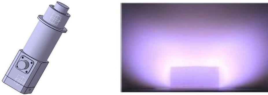
**Figure 5.5.** *Vue en perspective d'une source élémentaire à aimant tête-bêche (à gauche). Photo d'un plasma d'argon généré par micro-ondes à 2,45 GHz dans une source élémentaire tête-bêche (à droite).*
