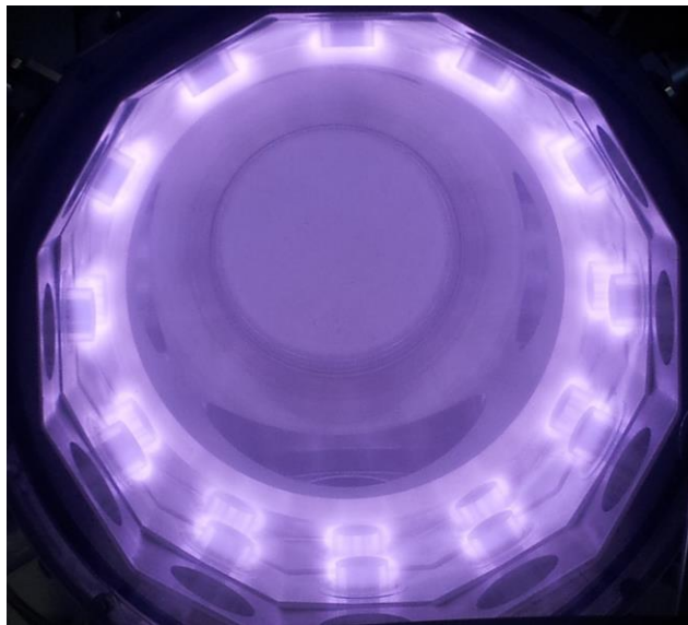
Figure 5.16. Vue de dessus du réacteur en configuration 3C (3 couronnes) (plasma d'argon : pression 10 mTorr et 100 W de puissance micro-onde à 2,45 GHz par source).
