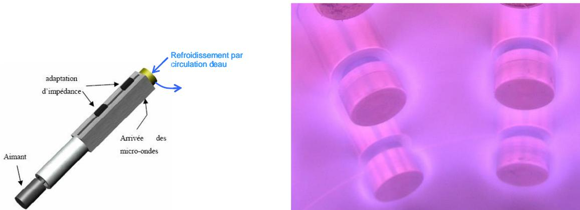
**Figure 5.2.** *Vue en perspective d'une source élémentaire dipolaire (à gauche).
