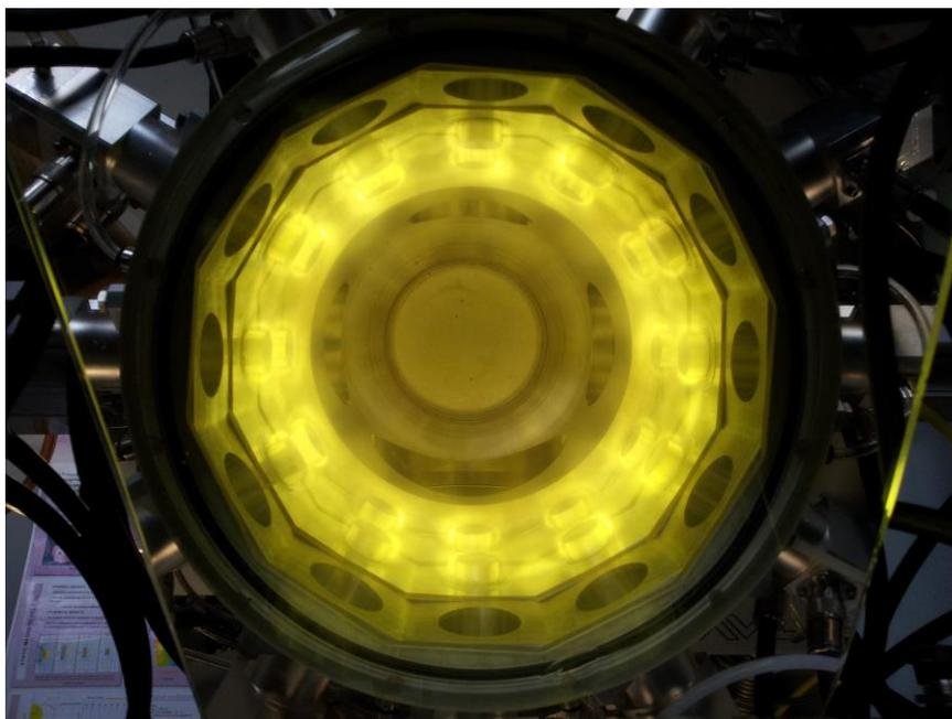
**Figure 5.23.** Vue de dessus du réacteur en configuration 3C avec un plasma d'oxygène à 10 mTorr et une puissance micro-onde à 2,45 GHz de 100 W par source.
