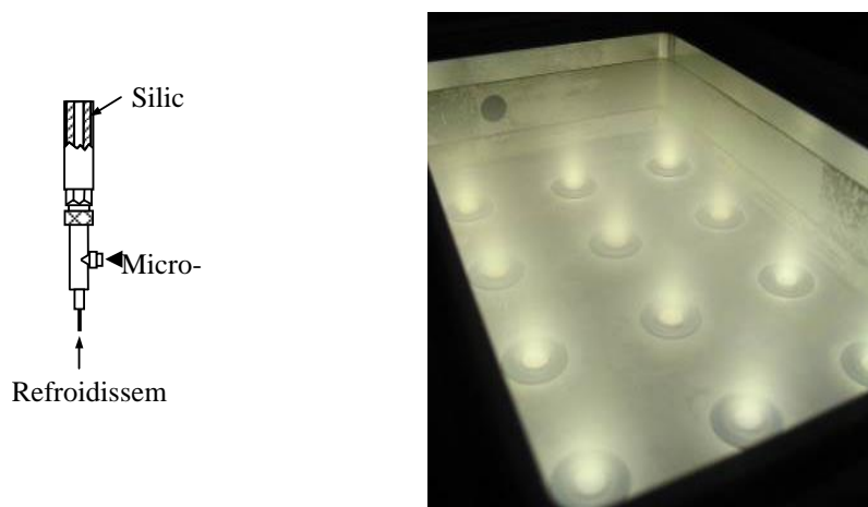
Figure 5.3. Schéma de principe d'un applicateur pour plasma matriciel (à gauche). Photo d'un plasma d'oxygène généré par micro-ondes à 2,45 GHz dans un réacteur matriciel (à droite).
