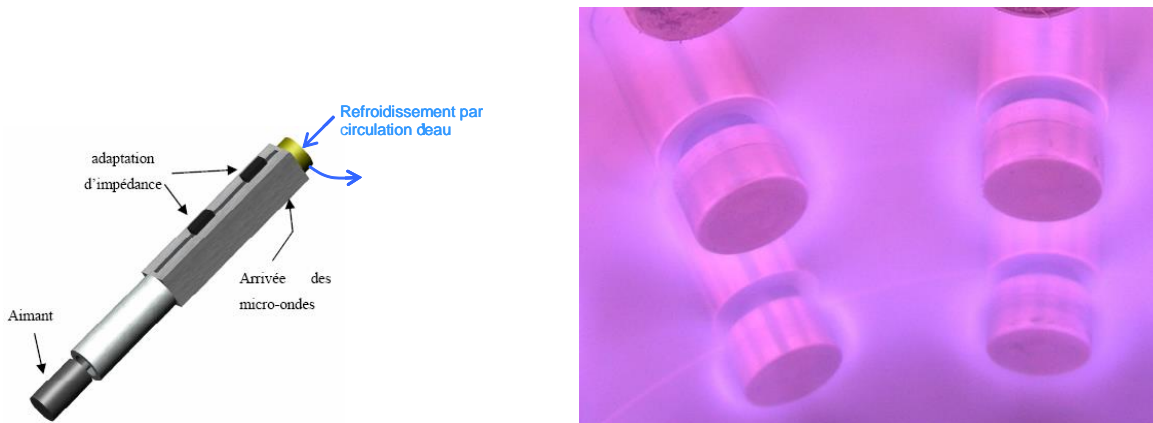
Figure 5.2. Vue en perspective d'une source élémentaire dipolaire (à gauche). Photo d'un plasma d'argon généré par micro-ondes à 2,45 GHz dans un réacteur multi-dipolaire (à droite).
