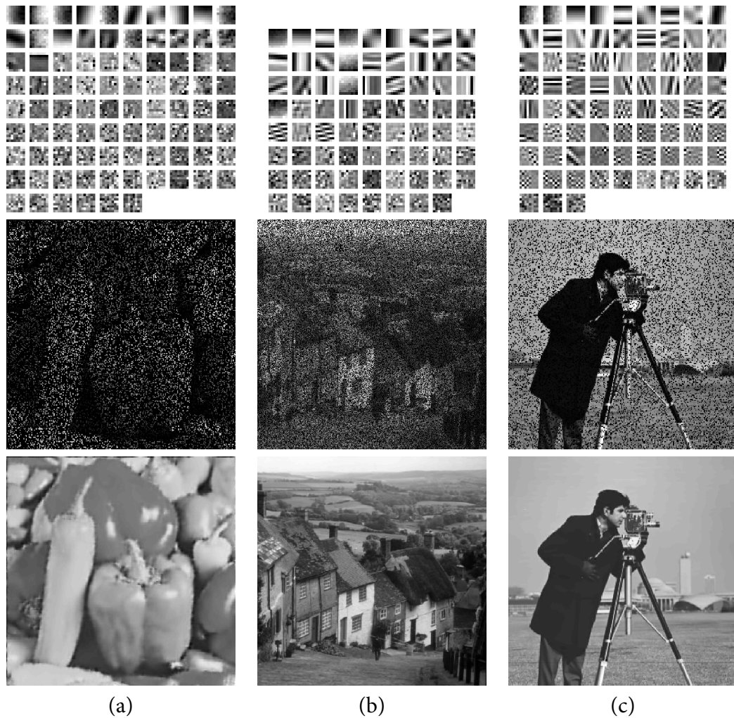
FIGURE 8.9 – Illustration des résultats typiques de l'inpainting obtenus en utilisant IBP-DL. De haut en bas, on a le dictionnaire inféré par IBP-DL, l'image masqué et l'image démasqué; (a) Peppers (80% de pixels manquants), PSNR de 6.53 dB à 26.05 dB, (b) Hill (50% pixels manquants) PSNR de 8.70 dB à 33.82 dB, (c) Cameraman (20% de pixels manquants) PSNR de 12.48 dB à 35.14 dB.
