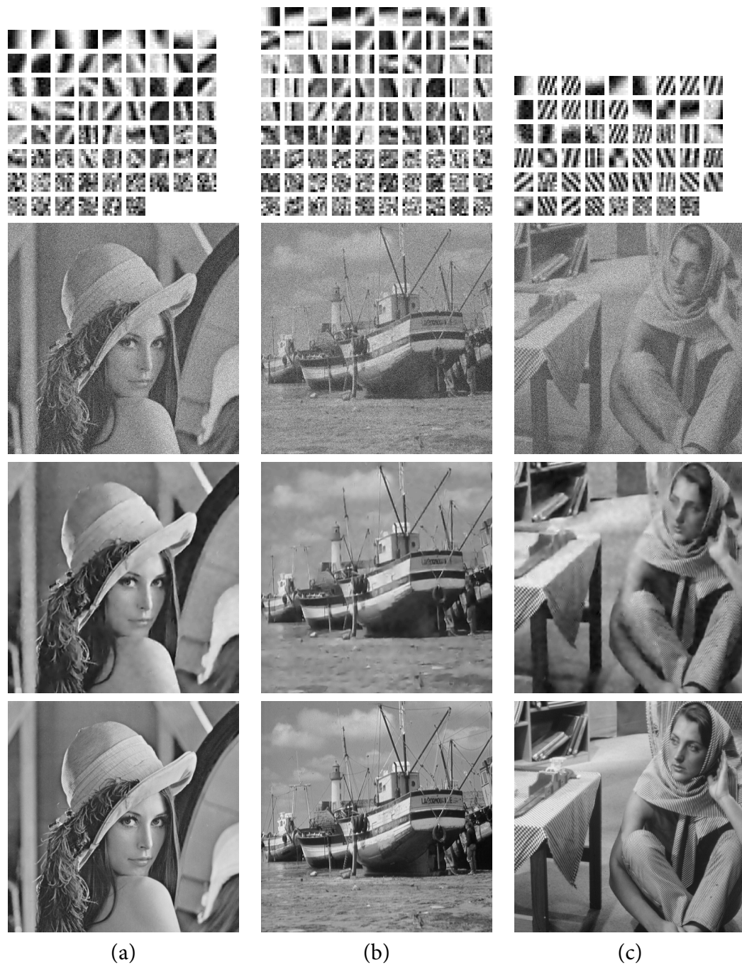
FIGURE 8.5 – Résultats de débruitage obtenus en utilisant IBP-DL. De haut en bas on trouve le dictionnaire IBP-DL, l'image bruitée, l'image débruitée et l'image originale; (a) Lena, PSNR de 20.17 dB à 31.12 dB, (b) Boat, PSNR de 20.17 dB à 28.92 dB, (c) Barbara, PSNR de 16.08 dB à 26.34 dB.
