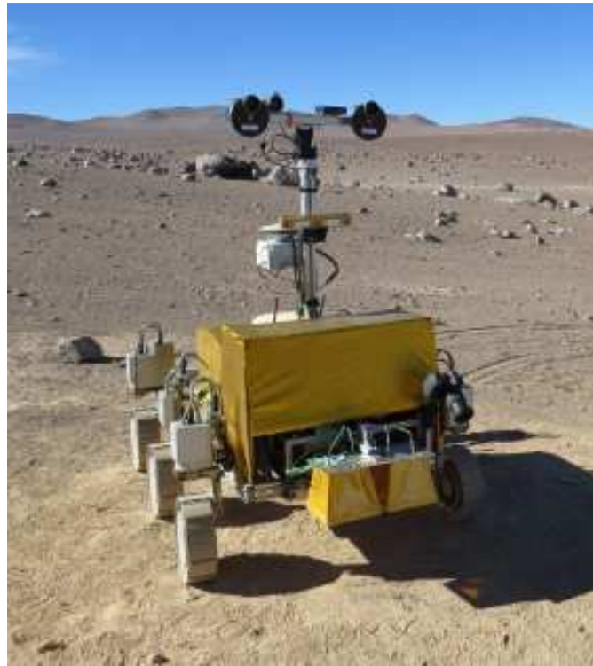
Figure 2.4-7 : Prototype de WISDOM monté sur un rover lors d'une campagne de mesures dans le désert d'Atacama au Chili. Les antennes sont remarquables à l'avant du rover. Source : LATMOS.
