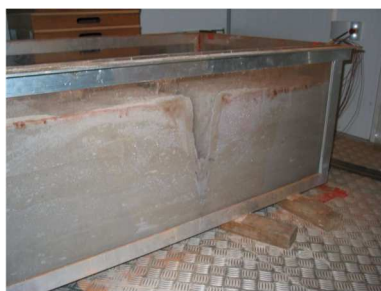
Figure 4.3-2 : Expérience conduite en chambre froide au laboratoire GEOPS avec une fente polygonale vide.
