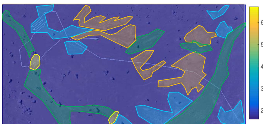
Figure 5.4-5 : Répartition spatiale de la constante diélectrique en surface déduite des mesures le long du trajet du rover.
