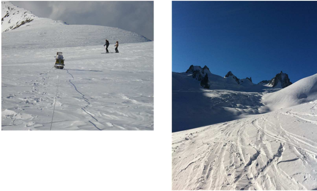
Figure 2-7 : Gauche : photographie de la zone n°1 située au niveau de l'arrivée du téléphérique des Grands Montets, Chamonix. Droite : zone n°2, sur la Vallée Blanche, Chamonix. Les sondages ont été effectués avec l'instrument WISDOM monté sur une luge pour faciliter les déplacements et la fiabilité du pas de 10 cm entre les mesures.
