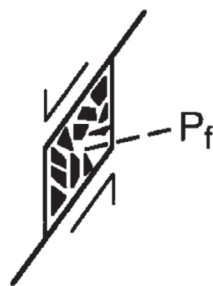
Fig. 1.27 – Mécanisme de pompage par succion dans une zone de relai extensif d'après Sibson, 2000. Chaque réactivation sismique du plan de faille s'accompagne d'une chute de pression fluide dans la zone de faille et à la formation d'une brèche d'implosion.
