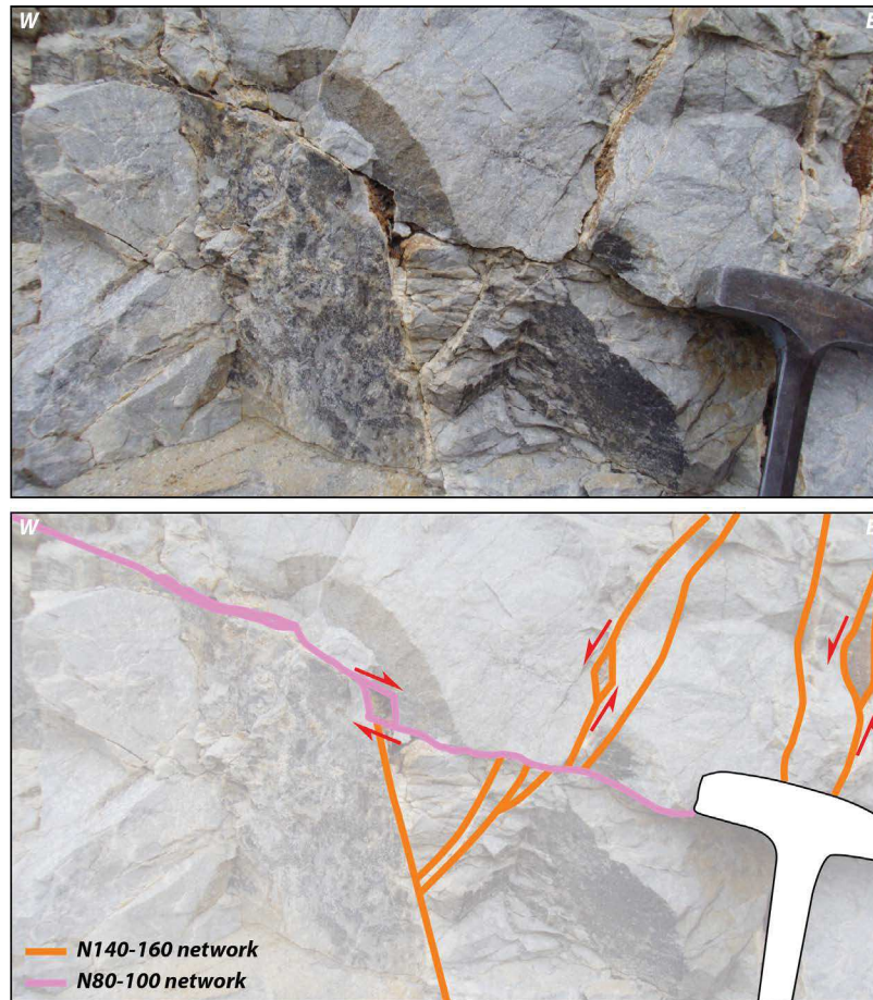
Fig. 2.61 – Décalage des familles de fractures N140-160 par le jeu normal/dextre des fractures N80-100 (Parement 2 zone 1).
