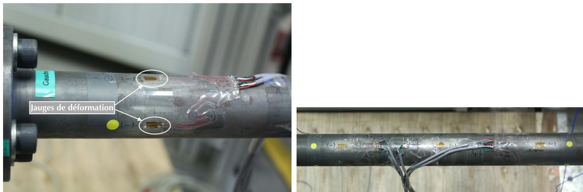
(a) Jauges collées dans les deux plans de symétrie (b) Jauges collées à  $0^\circ$  sur la poutre droite
