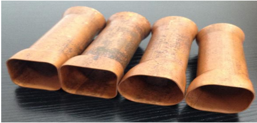
Figure.4.6. Tubes en fin de mise en forme
