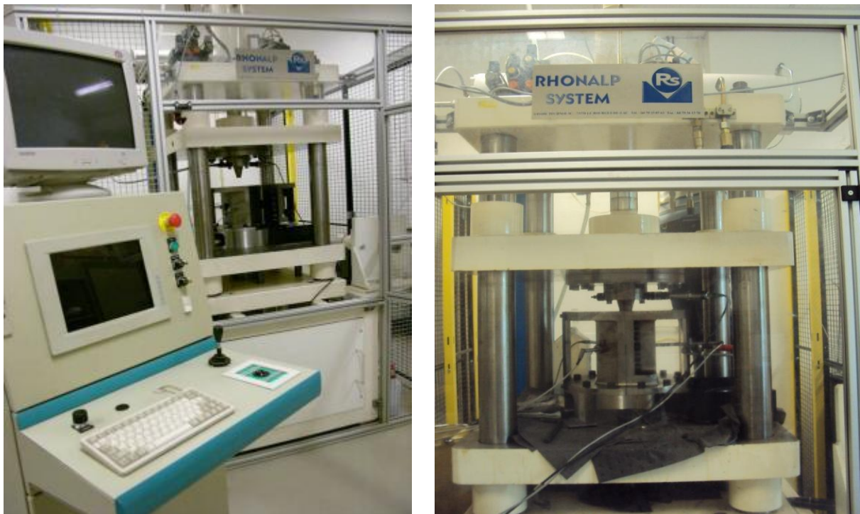
Figure.3.5. Machine d'hydroformage de tubes.
