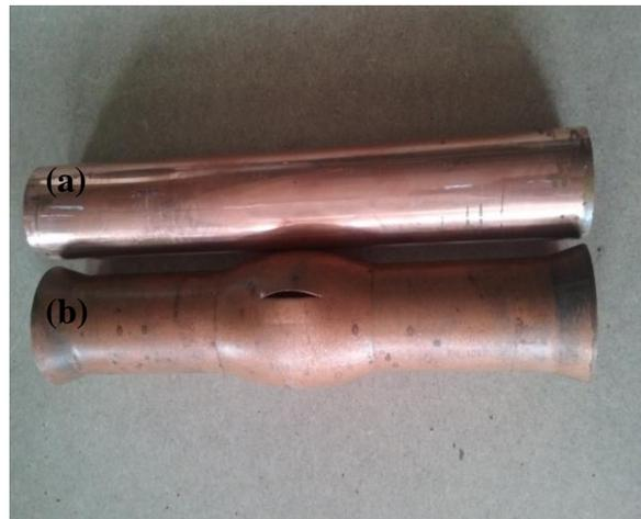
**Figure.3.1.** Déformation sous l'action d'une même pression interne d'un tube écroui (a) et d'un tube ayant subi le recuit à 450°C pendant 30 minutes suivi d'un refroidissement à l'air ambiant (b).
