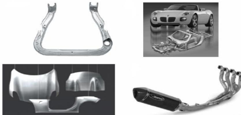
**Figure.1.1.** Exemples de pièces obtenues par hydroformage [Maki et Walter 2007].
