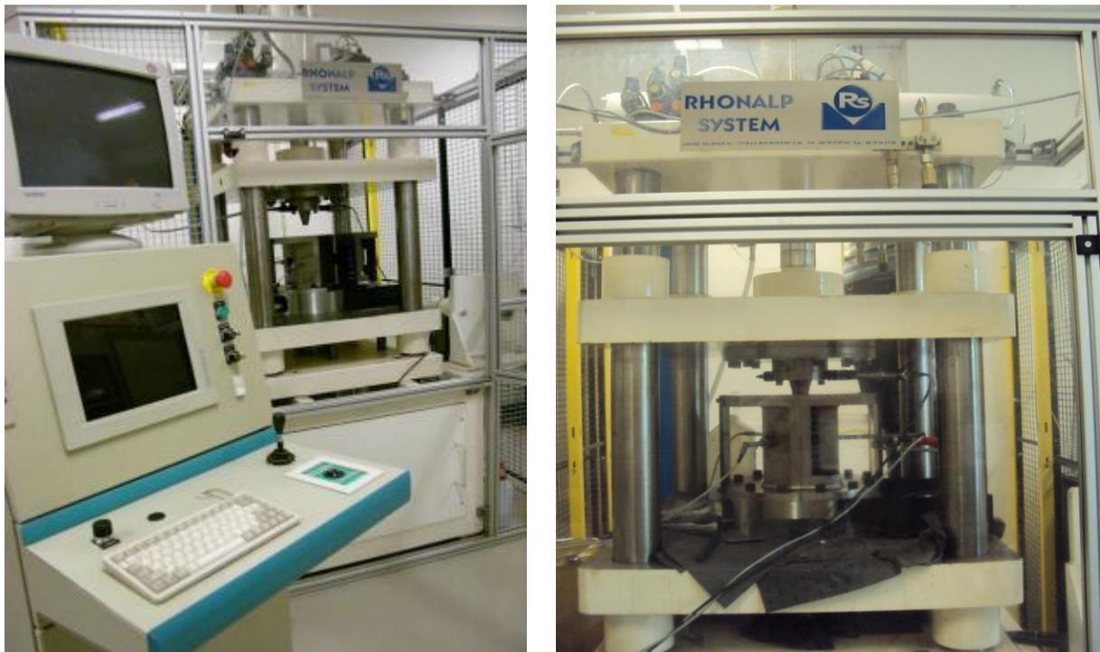
**Figure.3.5.** Machine d'hydroformage de tubes.
