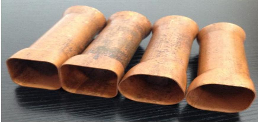
**Figure.4.6.** Tubes en fin de mise en forme
