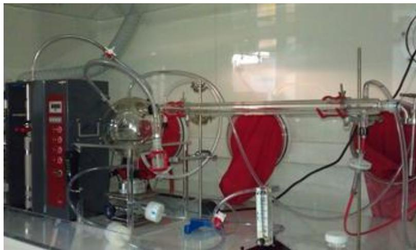
**Figure 34** Représentation schématique et photographie du dispositif expérimental (1) Nébuliseur Collision, (2) Colonne de séchage, (3) Chambre d'homogénéisation, (4) *Electrical Low Pressure Impactor* (ELPI), (5) Bio-collecteur SKC, (6) Impacteur Andersen
