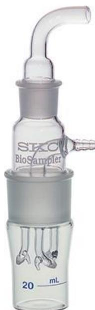
Figure 22 Photographie d'un Impacteur liquide SKC ([www.skcinc.com](http://www.skcinc.com))
