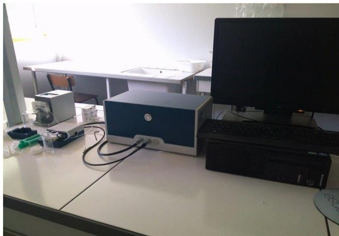
Figure 40 : Représentation de la microbalance à quartz utilisée
