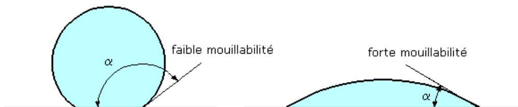
Figure 48 : Schématisation de la mouillabilité d'un liquide sur une surface solide.
