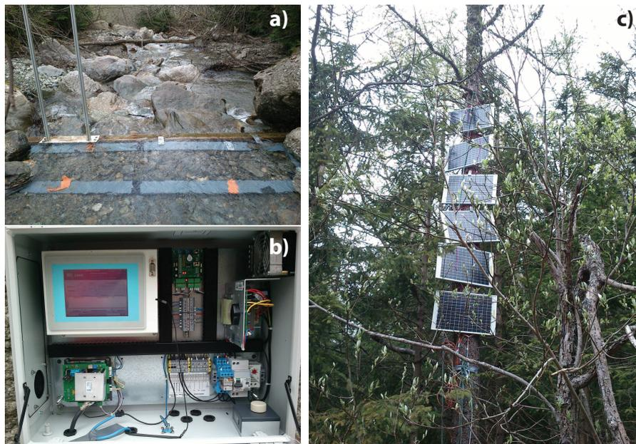
FIGURE 4.10 – Appareillage statique pour le suivi des galets marqués par PIT. a) Antenne fixe installée dans le lit du torrent des Bossons à la sortie du Plan des Eaux; b) Intérieur de la centrale d'acquisition de l'antenne RFID statique; c) installation des panneaux solaires permettant de recharger les batteries.
