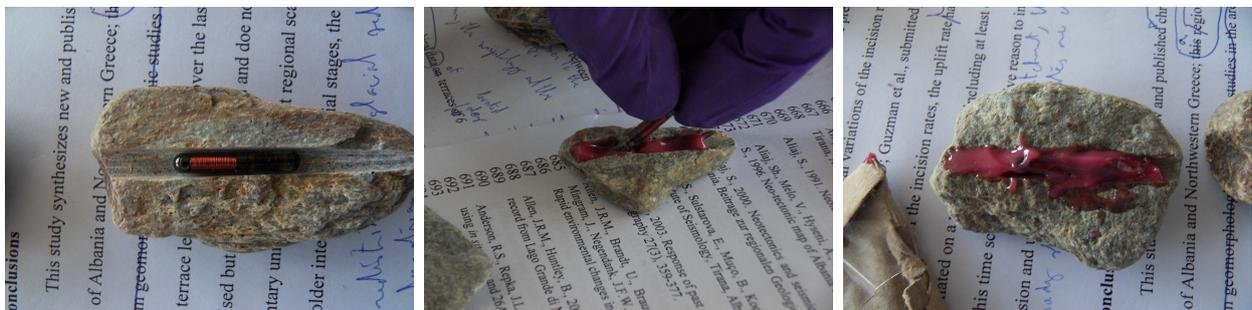
FIGURE 4.8 – Équipement d'un galet avec un PIT
