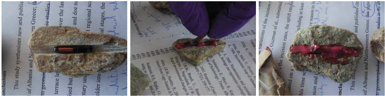
FIGURE 4.8 – Équipement d'un galet avec un PIT
