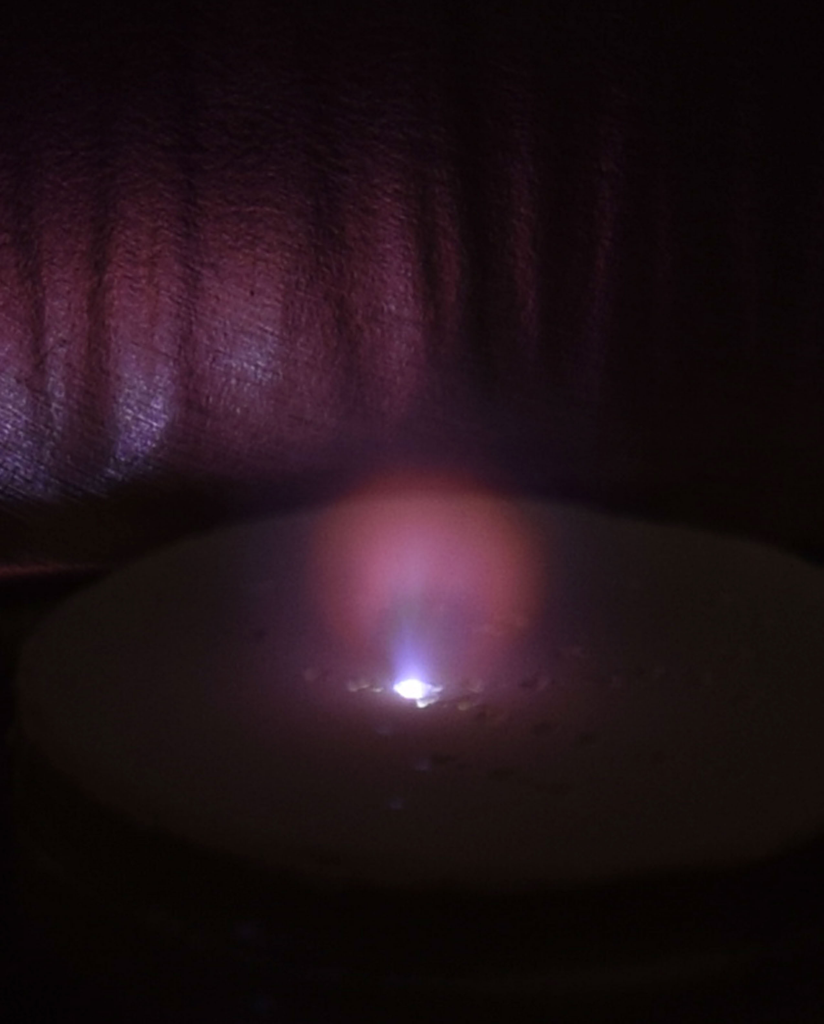
Plasma sur pastille d'hexahydrite (diamètre 1 mm) en conditions d'atmosphère martienne
