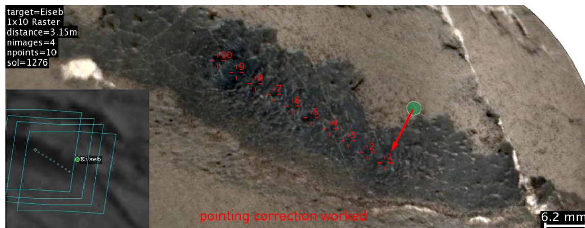
Figure 6-6 : Exemple de correction de pointage : la consigne de pointage pour la position de départ du raster diagonal (point vert) a été volontairement décalée de la cible (flèche rouge), en connaissance d'un offset systématique sur ce site lors de la planification des opérations.
