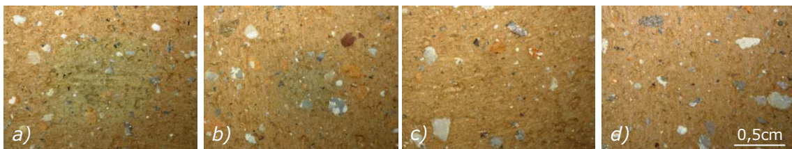
Figure 4.29 – Clichés en surface de produits soumis à une incorporation de 6% en FNO et portés à 600°C selon une rampe de 10 (a), 5 (b), 3 (c) et 1°C/min (d).
