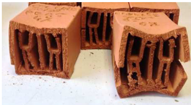
Figure 4.1 – Briquettes extrudées et cuites en dépit d'un défaut de plasticité.
