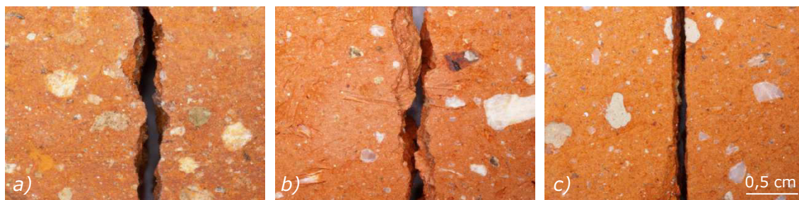
Figure 4.18 – Clichés des faces en traction après la rupture en flexion 3 points de produits usuels (a) et soumis à incorporation de 4% en PB_1 (b) et en FNO (c).
