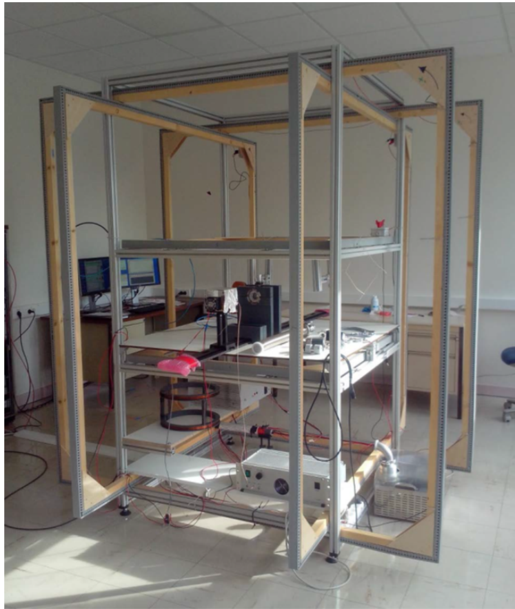
FIGURE 3.3 – Photographie du banc de test montrant l’agencement des bobines. La cellule cylindrique disposée au centre est orientée selon l’axe x et la direction verticale est définie par l’axe z . La structure en aluminium soutenant les bobines a une dimension de 1\text{ m} \times 1\text{ m} \times 2\text{ m} .
