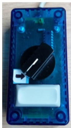
FIGURE 8.3: Le potentiomètre : dispositif de réponse utilisé dans les quatre conditions expérimentales. Le bouton circulaire noir est sur sa position de départ. En le tournant dans le sens des aiguilles d'une montre, le participant fait défiler rapidement les grandeurs de 6 à 200 à l'écran, dans un ordre croissant avec un pas de un. Pour valider sa réponse, il appuie sur le bouton poussoir gris.
