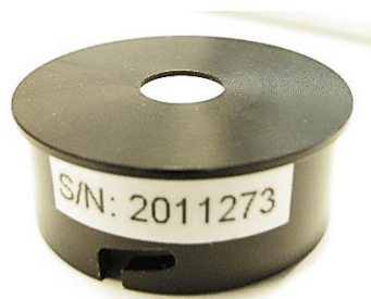
Fig 2.1.11 : Diffuseur cosinus du SPECBOS 1211UV Jeti.
