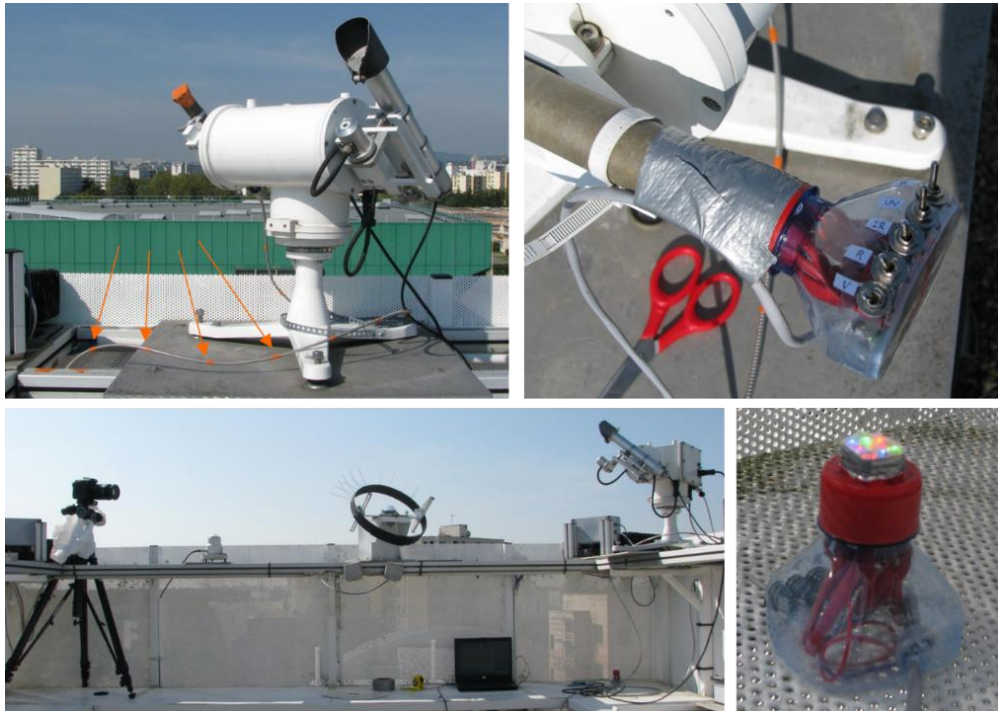
Fig 2.2.12 : Dispositif expérimental utilisé pour l'étude des effets de la courbure de la fibre optique sur la fonction de transfert spectrale de la chaîne sesn . En haut à gauche, une photo prise par un des deux appareils photo. On y observe, sur la fibre optique, les bagues de référence permettant de déterminer le profil de courbures. En haut à droite la source installée sur le tube de la chaîne sesn . En bas à gauche, un des 2 appareils photo observant le suiveur. En bas à droite la source à LEDs et ses 5 LEDs (396, 462, 524, 632, 853nm).
