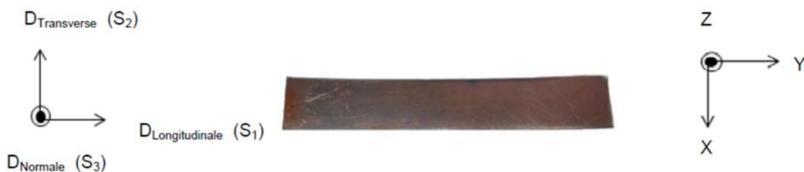
Figure 104 : schéma de l'orientation d'un échantillon de T91 lors des analyses de détermination de contrainte par DRX.
