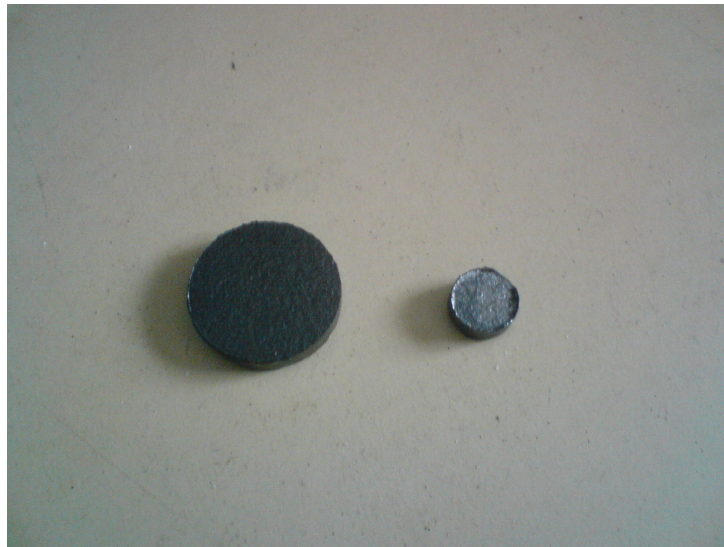
FIGURE 4.17 – Exemple de pastilles de ferrite en sortie de frittage PECS. Diamètre 20 et 8 mm.
