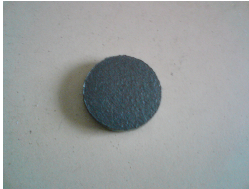
FIGURE 6.4 – Ferrite réalisé par frittage réactif.
