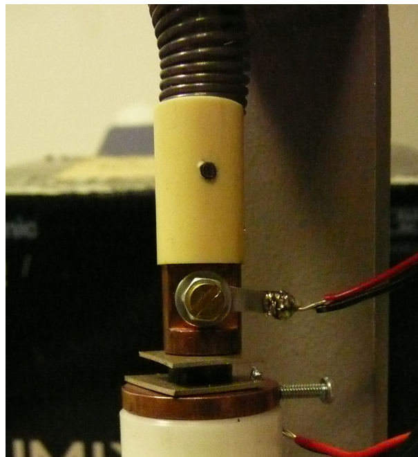
FIGURE 6.13 – Mesure de la résistivité des ferrites.
