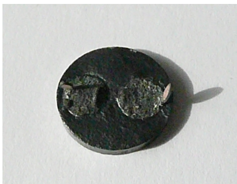
FIGURE 7.25 – Transformateur de la série des deuxièmes essais. Les quatre contacts se trouvent sur le dessus. Diamètre 20 mm.
