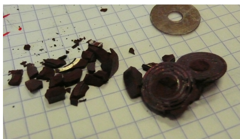
FIGURE 6.19 – Après recuit à 500 °C, les transformateurs s'effritent facilement.
